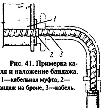
Рис. 41. Примерка кабеля и наложение бандажа.
