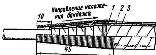
Рис.55. Герметизация однопроволочной жилы.
