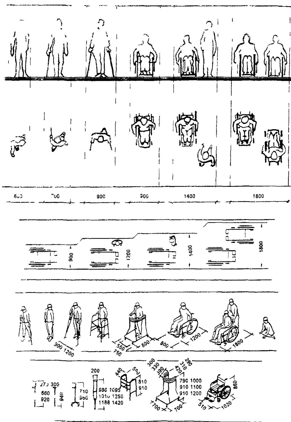
Рис 3.4 НЕОБХОДИМЫЕ ГАБАРИТЫ КОММУНИКАЦИИ УСТРОЙСТВ
