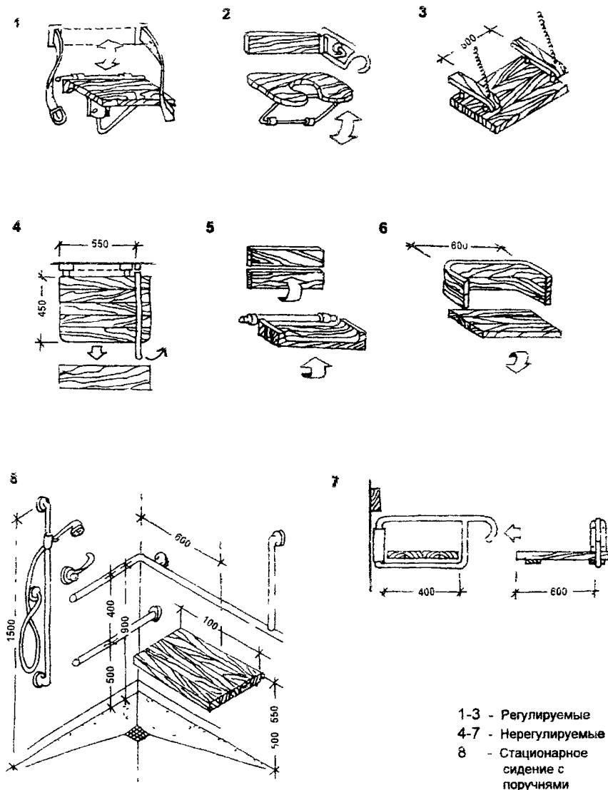
РИС 3.12. ТИПЫ СТАЦИОНАРНЫХ СИДЕНИЙ В ДУШЕВЫХ
