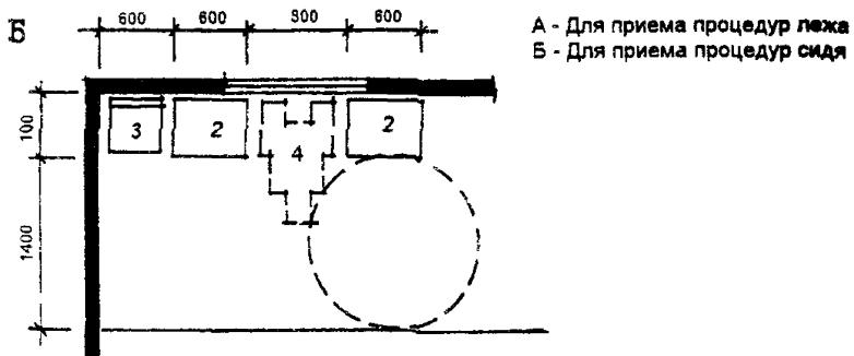
РИС 6.7 ФРАГМЕНТЫ РАЗМЕЩЕНИЯ ОБОРУДОВАНИЯ В КАБИНЕТАХ ЭЛЕКТРОСВЕТОЛЕЧЕНИЯ
