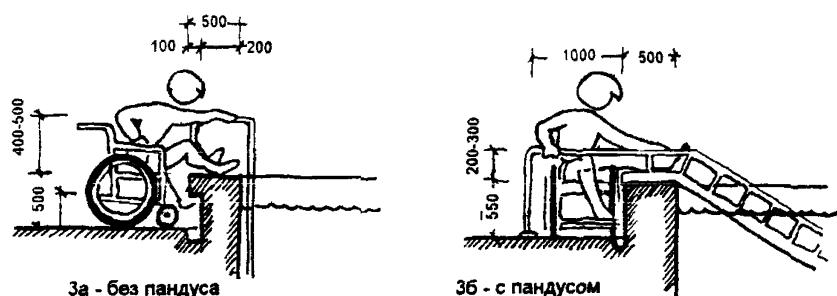
РИС.7.3. ПРИМЕРЫ РАЗЛИЧНЫХ ПРИСПОСОБЛЕНИЙ ДЛЯ ВХОДА ИНВАЛИДОВ В БАССЕЙН
