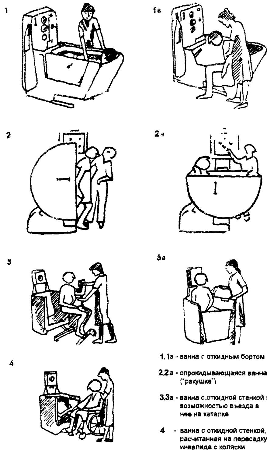
РИС. 6.14. ТИПЫ ОБОРУДОВАНИЯ, ПРИМЕНЯЕМОГО ДЛЯ ВОДОЛЕЧЕНИЯ ИНВАЛИДОВ
