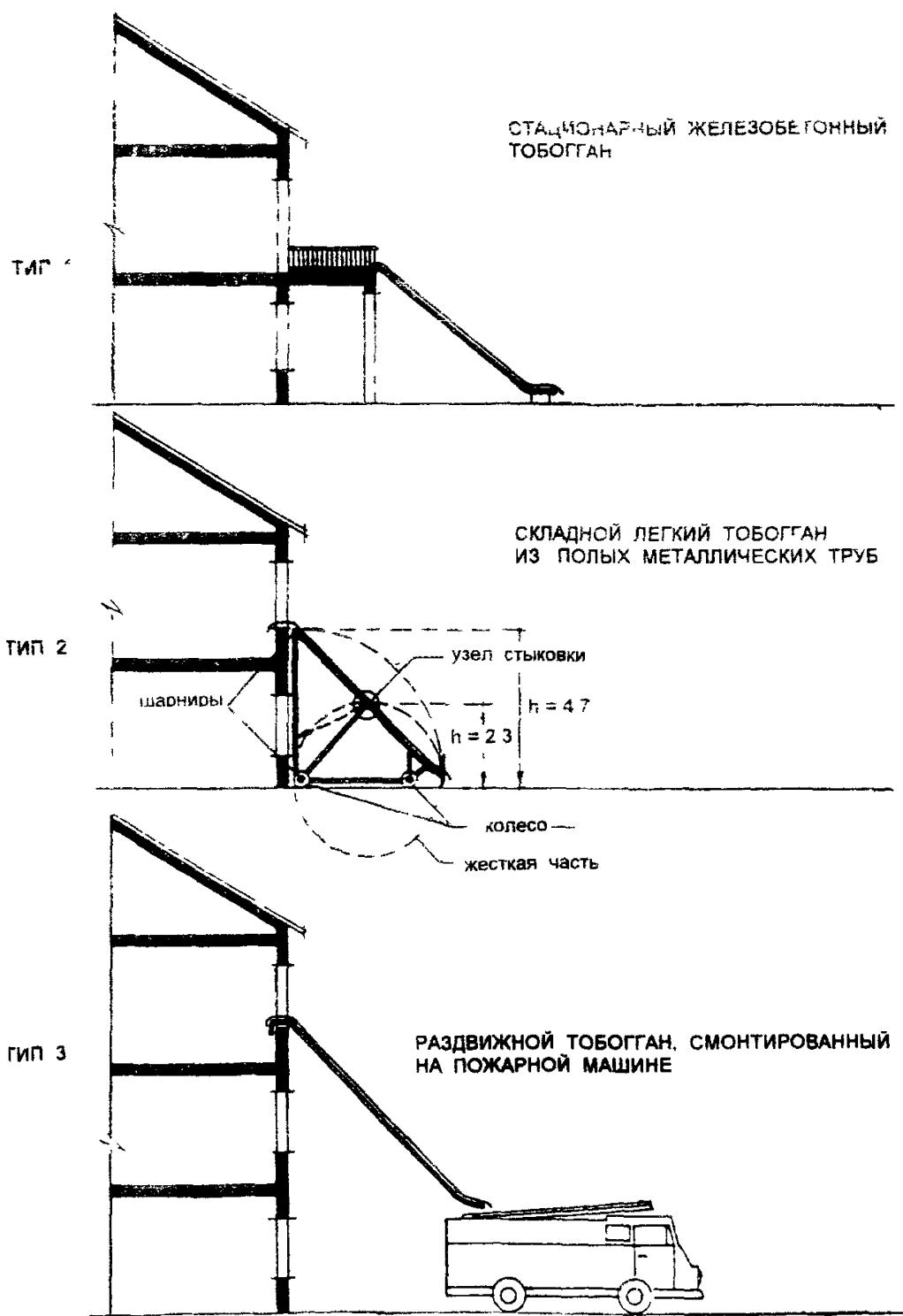
РИС 3.11 СХЕМЫ ТОБОГГАНОВ
