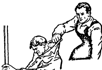
Освобождение пострадавшего от тока в установках до 1000 В оттащиванием за сухую одежду
