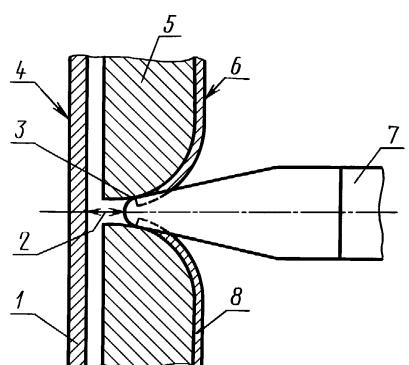
1 — часть под опасным напряжением; 2 — зазор; 3 — точка, от которой измеряется путь утечки; 4 — внутренняя поверхность; 5 — задняя стенка; 6 — внешняя поверхность; 7 — испытательный палец; 8 — мнимый токопроводящий слой
