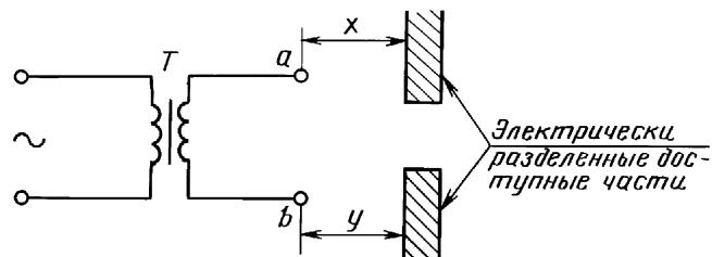
T — разделительный сетевой трансформатор; a, b —
