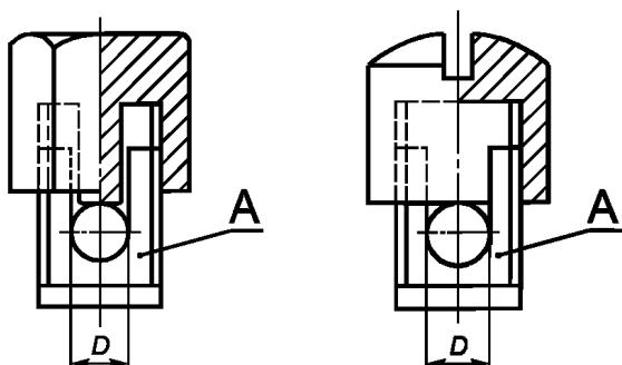
*A* — закрепленная часть; *D* — пространство для проводника
