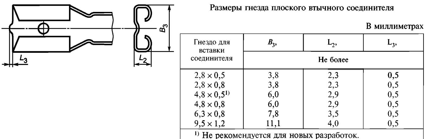
Рисунок 8 — Охватывающие соединители (гнезда) плоских втычных соединителей
