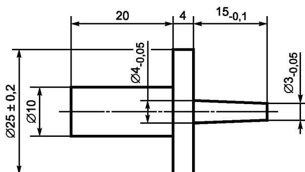
Рисунок 13 — Испытательный стержень
