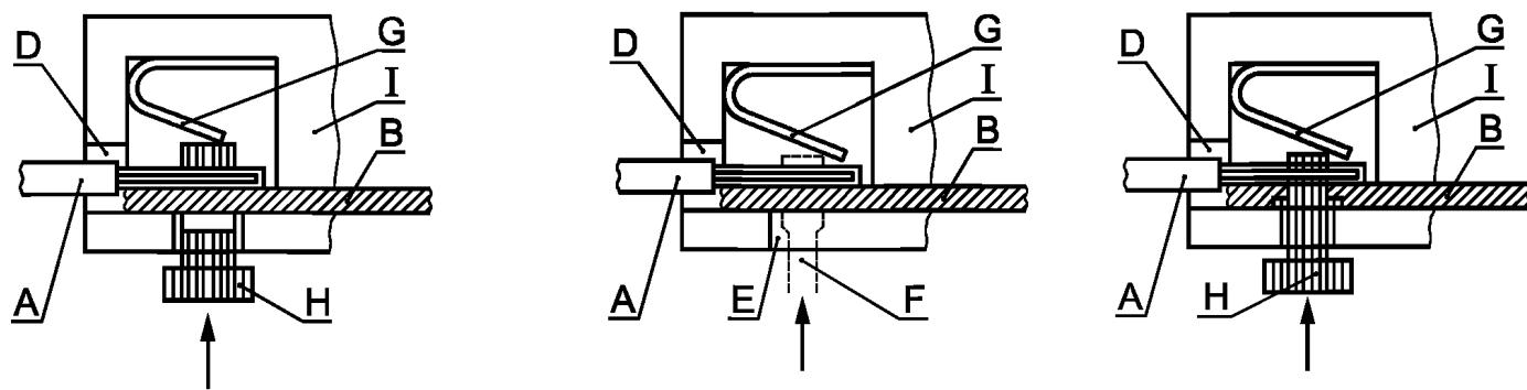
а) Безвинтовой зажим с зажимающими средствами косвенного действия, ослабляемыми с помощью приводного элемента.
