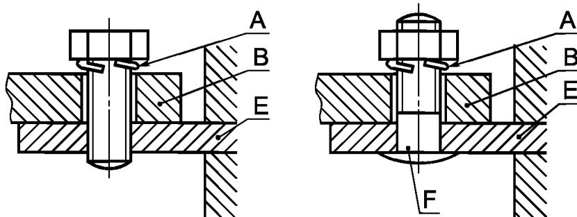
*A* — фиксирующие средства; *B* — наконечник провода или шина; *E* — закрепленная часть; *F* — шпилька
