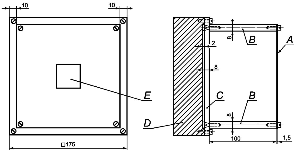
*A* — сменная стальная пластина; *B* — алюминиевая пластина; *C* — лист фанеры; *D* — стальная опора массой  $(10 \pm 1)$  кг;
