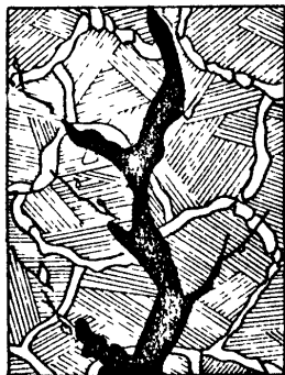
Рис. 8. Трещины, обусловленные действием ударных нагрузок. X100
