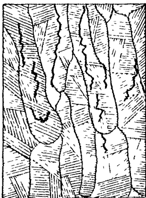
Рис. 4. Кристаллизационные трещины в металле шва. X100
