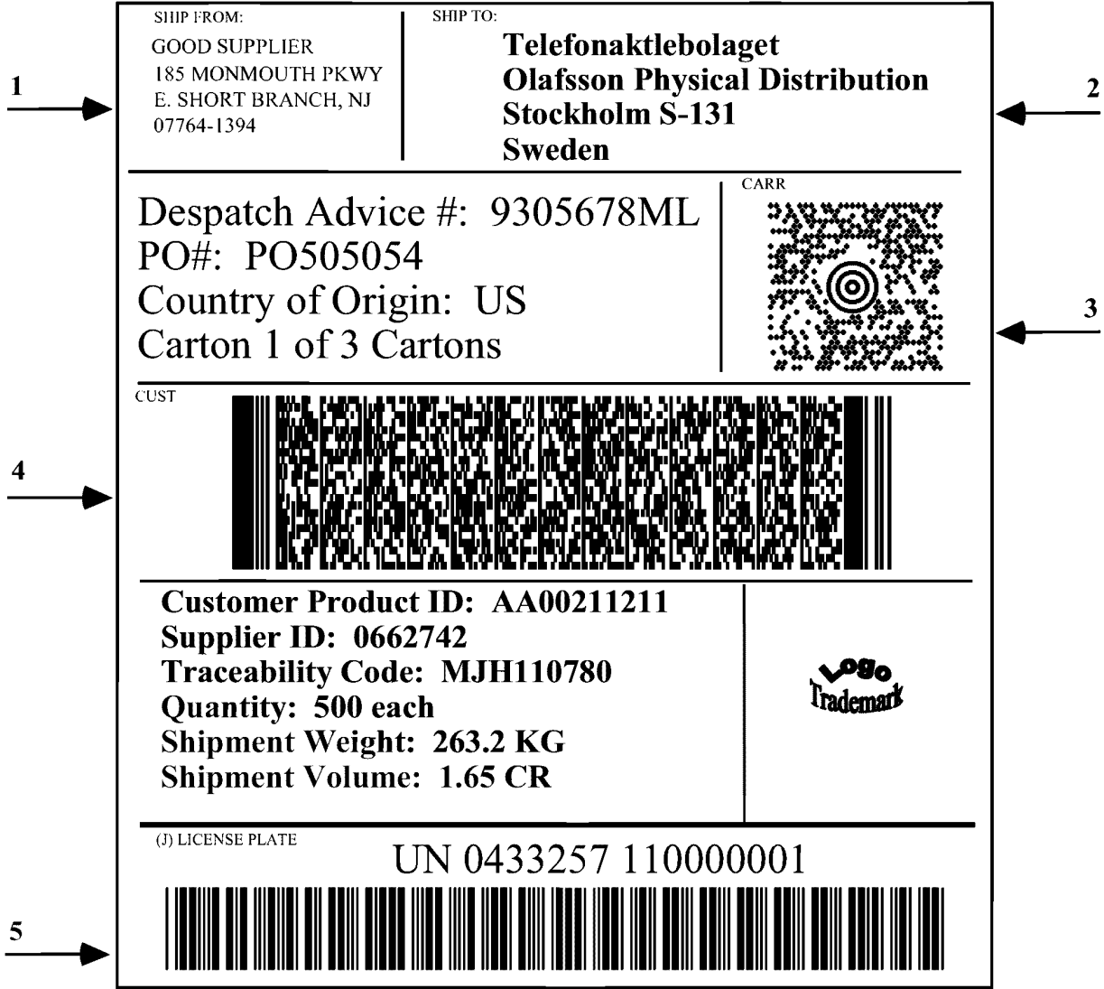
1 — отправитель; 2 — получатель; 3 — двумерный символ для сортировки/отслеживания груза перевозчиком; 4 — двумерный символ с данными получателя или заказчика; 5 — уникальный идентификатор транспортируемой единицы в символическом коде 39 с идентификатором данных J
