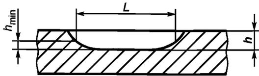
Длина  $L$  определяется участком, где  $h_{\min} \geq 0,5 h$
