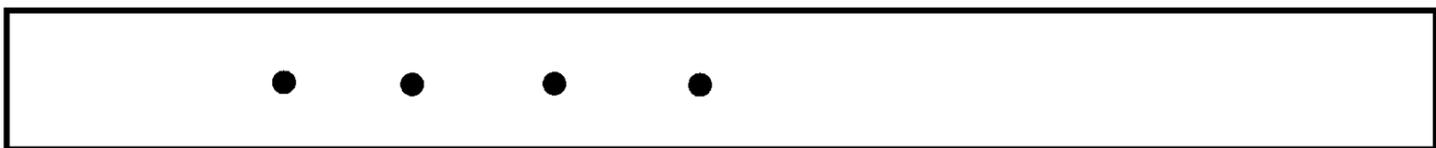
Пример 4 — четыре несплошности диаметром по 1,6 мм
