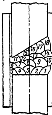
Рис. 6.20. Техника механизированной сварки СОДГП вертикальных стержней а - очередность наплавки слоев; б - техника наплавки слоев шва; К - точка касания проволокой стержня для возбуждения дуги
