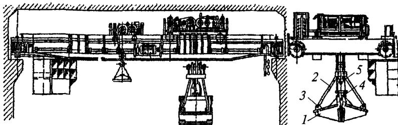
Рис. 6.1.1. Мостовой магнитно-грейферный кран
