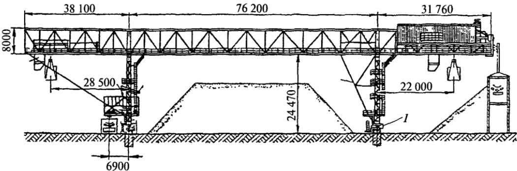
Перегружатель конструкции СКМЗ грузоподъемностью 40 т
