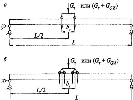
**Рис. 7.2.** Схемы к расчету прогибов пролетных балок двухбалочных мостовых кранов и пролетных балок главных мостов литьевых кранов:
