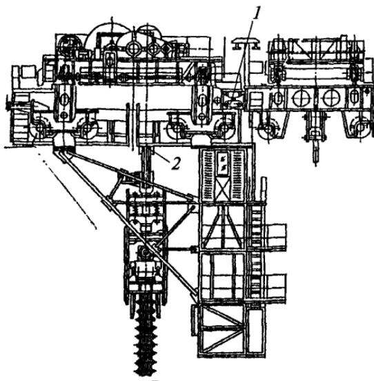
Рис. 6.12.1. Кран ковочный (вид сбоку)
