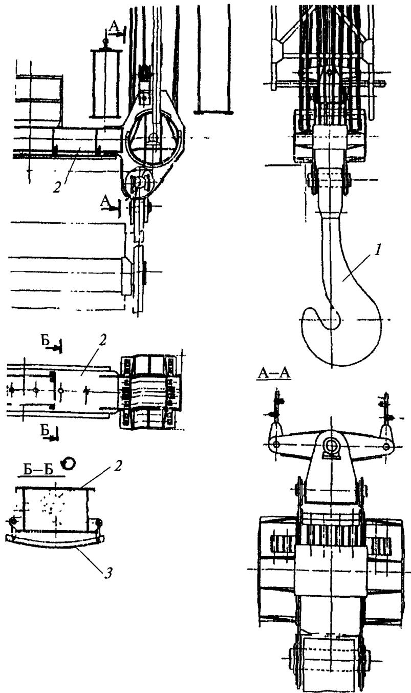
Рис. 6.4.2. Траверса литьевого крана
