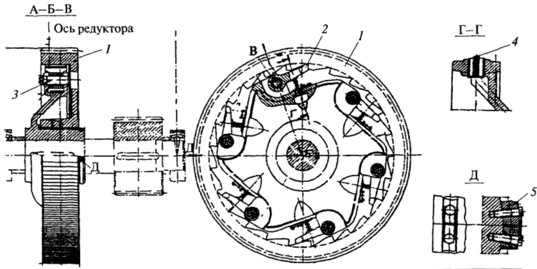
Рис. 6.4.3. Храповая передача
