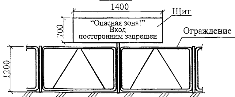
Рисунок 23 – Схема раскладки дорожных плит и установки ограждения
