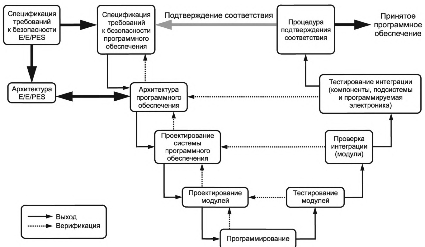
Рисунок 5 — Полнота безопасности программного обеспечения и жизненный цикл разработки (V-модель)
