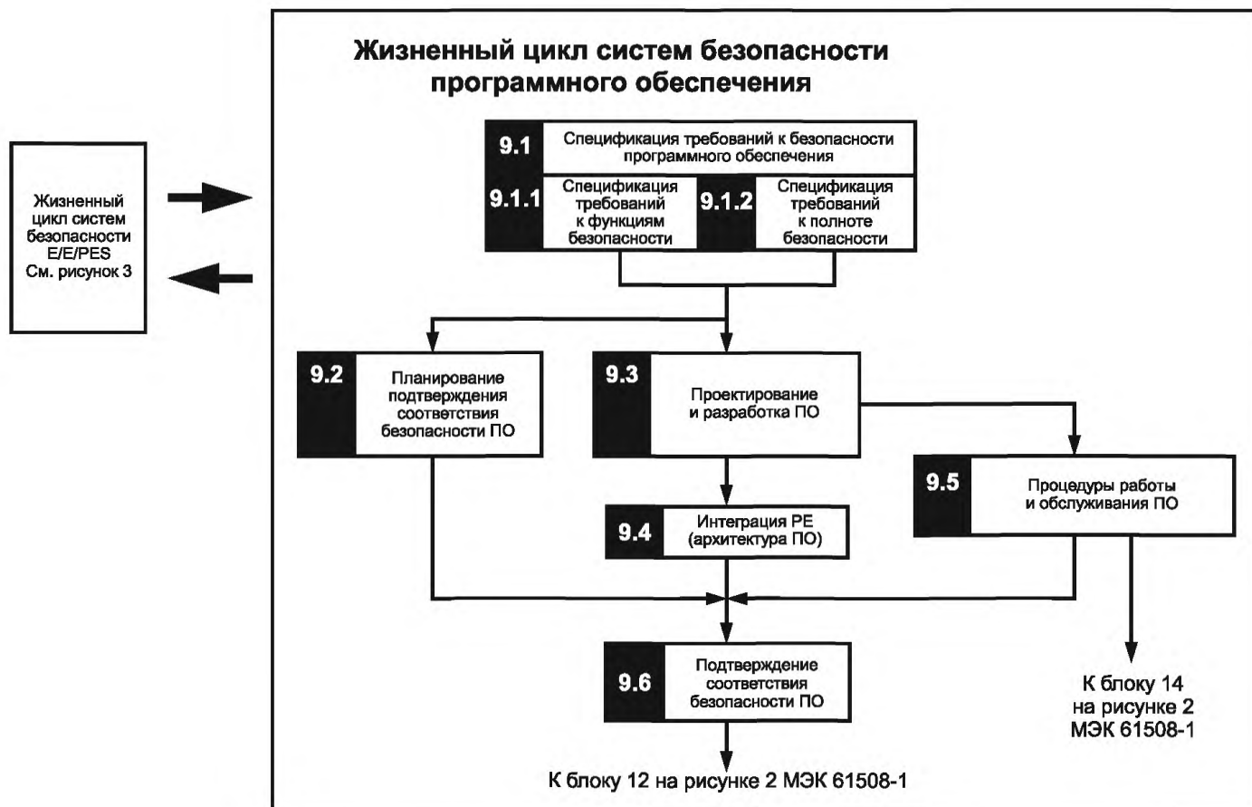
Рисунок 3 — Жизненный цикл безопасности программного обеспечения (стадия реализации)
