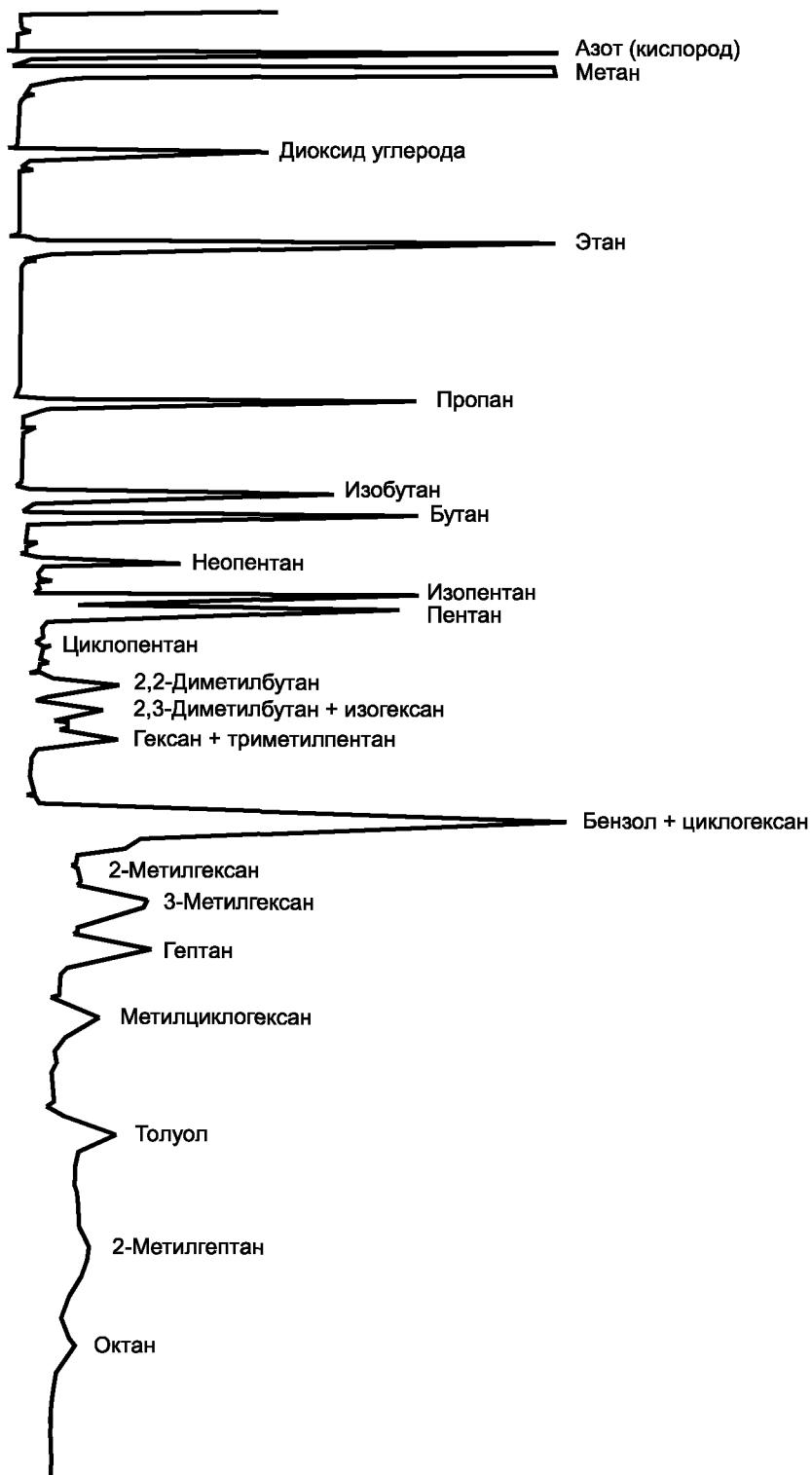
Рисунок А.2 — Типичная хроматограмма азота (кислорода), диоксида углерода и углеводородов от С<sub>1</sub> до С<sub>8</sub> на колонке с Porapak R
