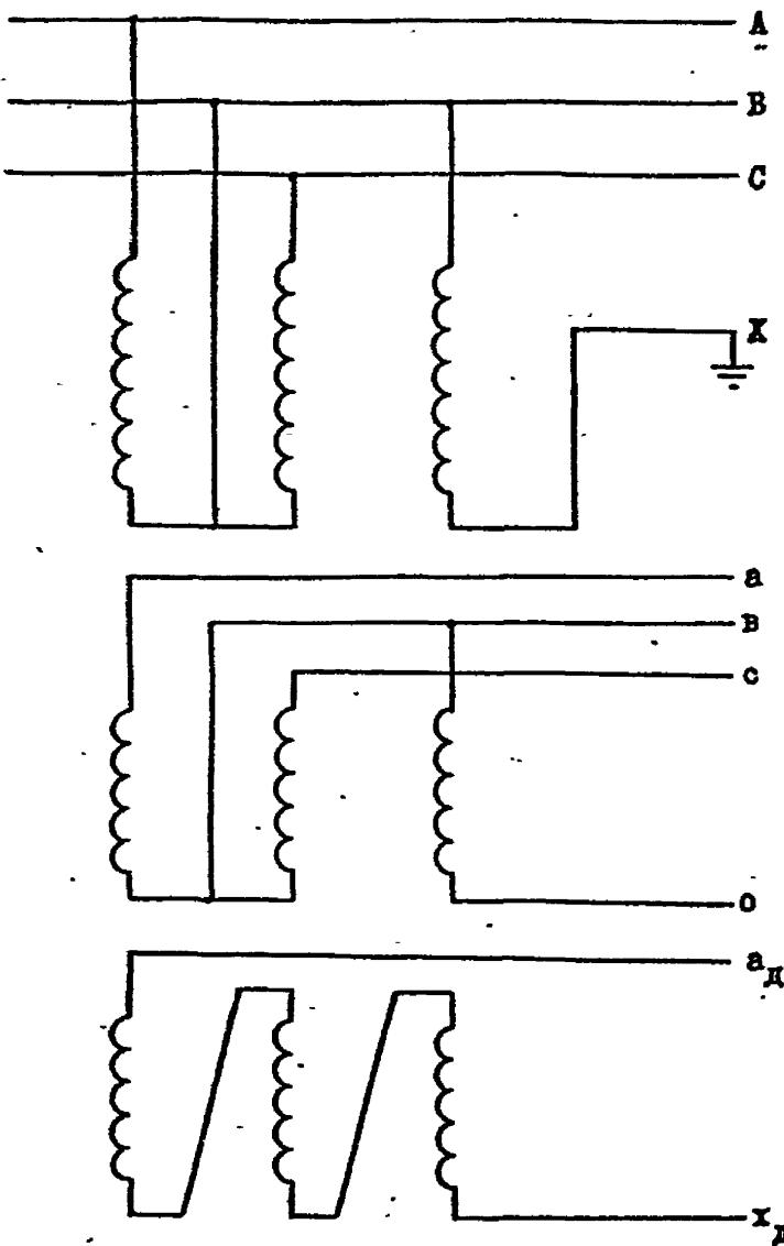
$$U_o = \frac{U_{A0} + U_{B0} + U_{C0}}{3} - \frac{U_{a0} + U_{b0} + U_{c0} + U_{d0}}{3} = U_{B0} + \frac{U_{a0} - U_{c0}}{3}.$$
