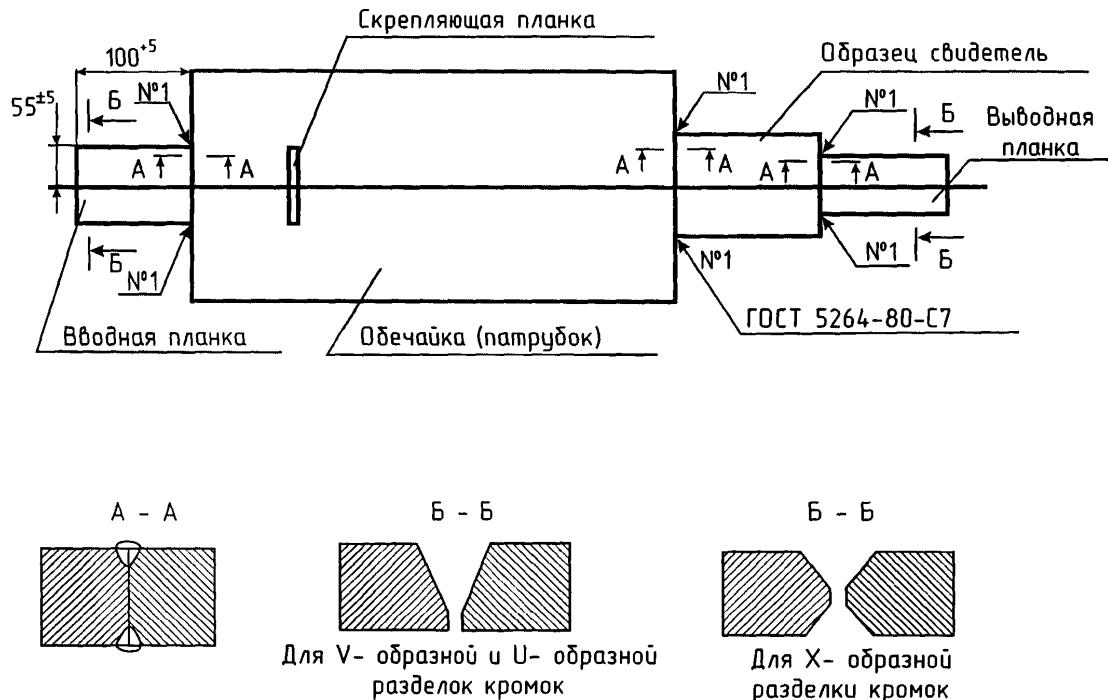
Рисунок 11.1 – Сборка продольных стыков под автоматическую сварку под флюсом
