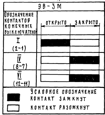
ДИАГРАММА ЗАМКЫКАНИЯ КОНТАКТОВ КОНЕЧНЫЕ ВЫКЛЮЧАТЕЛИ ЭЛЕКТРОМАГНИТНОГО ПРИВОДА ИМ
