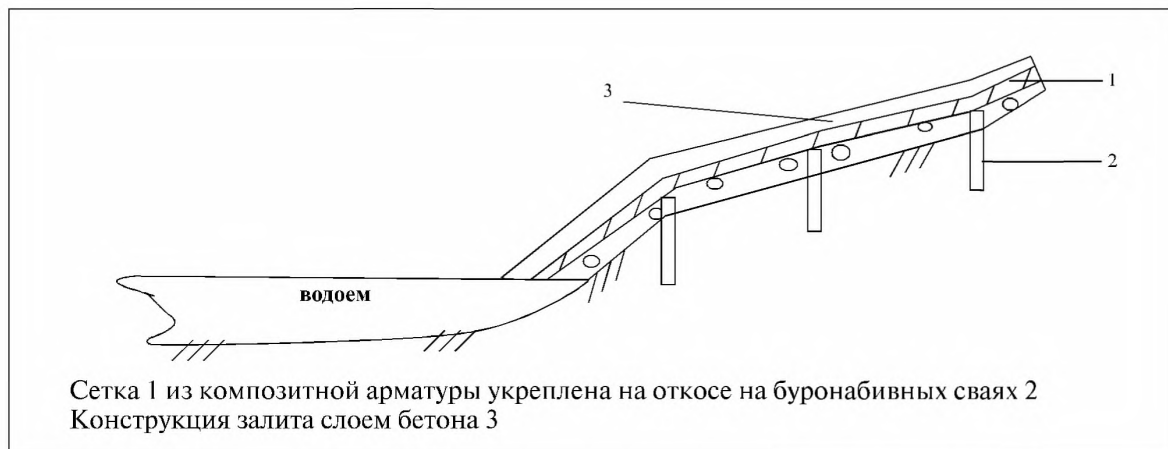
Рисунок 5. Монолитная конструкция укрепления откосов водоема
