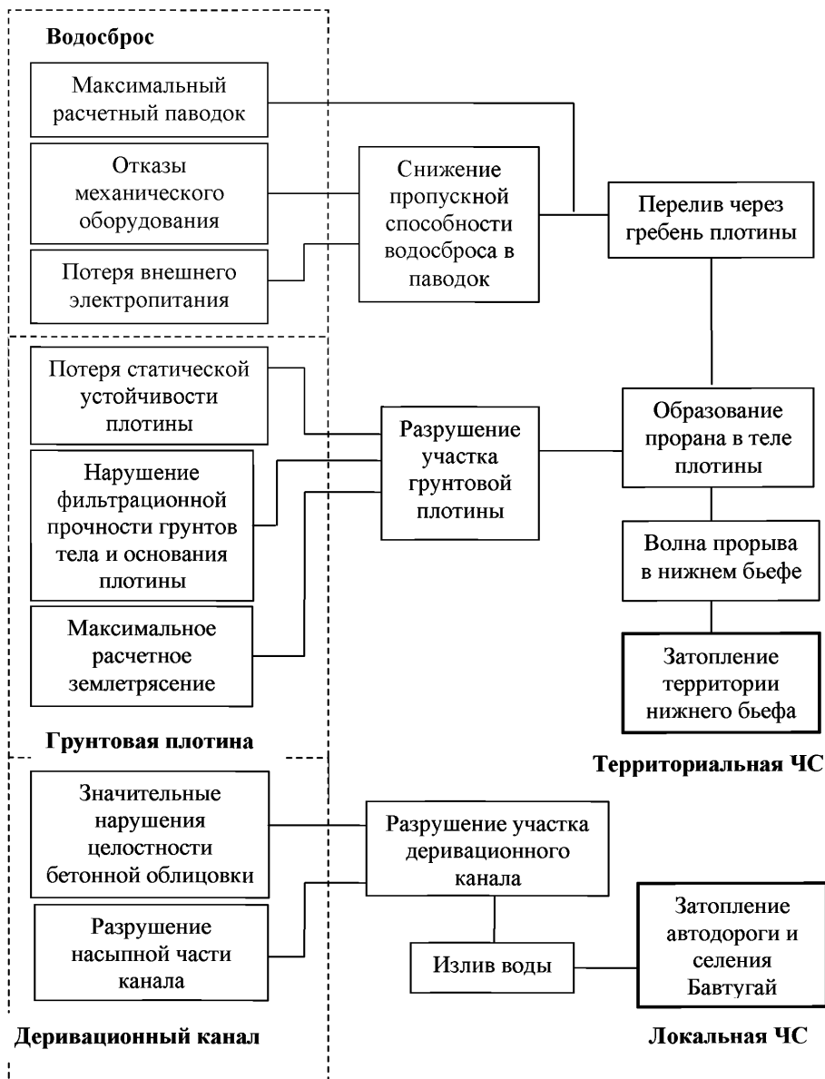
Рисунок Б.1 - Блок-схема анализа основных вероятных сценариев возникновения и развития аварий на ГТС Чирюртских ГЭС.
