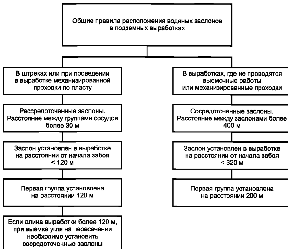
Рисунок 4 — Общие правила расположения водяных заслонов в подземных выработках
