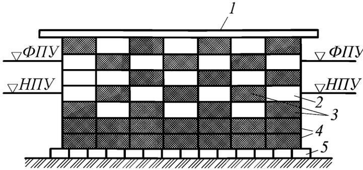
1 – бровка земляного полотна; 2 – ячейки, заполняемые другим материалом; 3 – матрацно-тюфячные габионы; 4 – два нижних ряда сплошного укрепления габионами; 5 – упор из коробчатых габионов; *НПУ* – нормальный подпорный уровень; *ФПУ* – форсированный подпорный уровень
