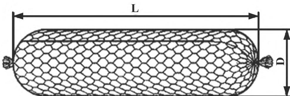
$L$  – длина цилиндрического ГСИ;  $D$  – диаметр цилиндрического ГСИ
