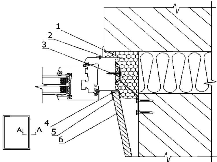
1 – пенный утеплитель; 2 – профиль из ПВХ; 3 – анкерная пластина; 4 – герметик;
