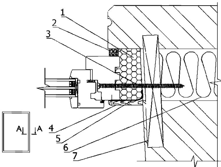
1 – пенный утеплитель; 2 – изоляционная саморасширяющаяся паропроницаемая лента; 3 – строительный шуруп; 4 – нащельник; 5 – пароизоляционная лента; 6 – утеплитель стены; 7 – закладная деталь
