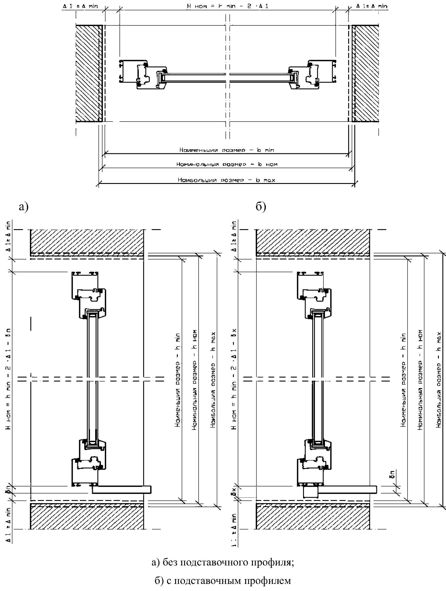
Рисунок 1 – Схема определения размеров оконных блоков в проемах наружных стен
