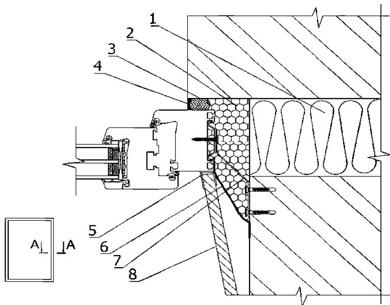
1 – утеплитель стены; 2 – пенный утеплитель; 3 – забутовочный шнур;
