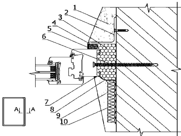
1 – штукатурка; 2 – профиль металлический (пластиковый); 3 – пенный утеплитель; 4 – забутовочный шнур; 5 – атмосферостойкий паропроницаемый герметик; 6 – шуруп по бетону; 7 – герметик; 8 – пароизоляционный герметик; 9 – штукатурка; 10 – теплоизоляционный вкладыш
