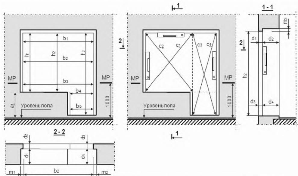
Рисунок А.4 – Схема замеров проема балконной двери прямоугольной конфигурации в наружной стене с четвертями
