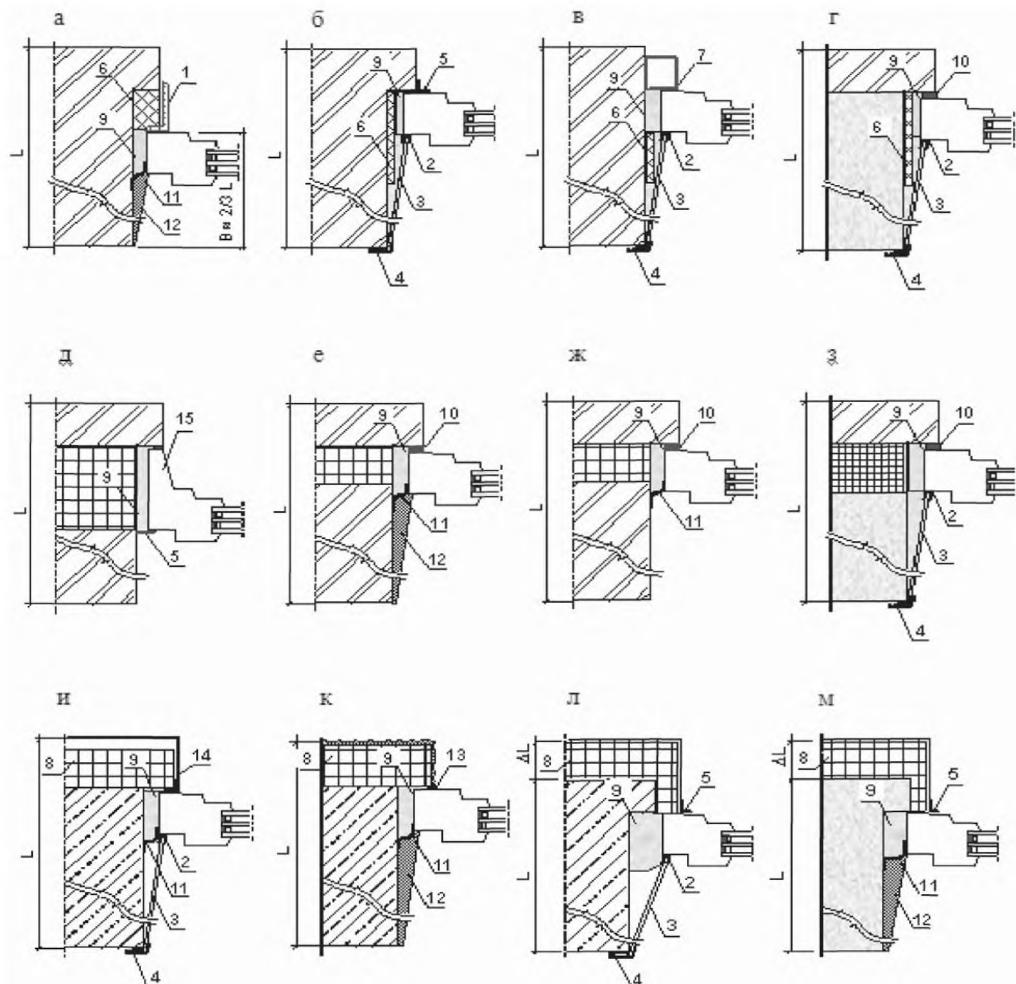
а, б, в, г – однослоиные или двухслойные стены без эффективного утеплителя; д, е, ж, з – многослойные стены с эффективным утеплителем, расположенным в толще стены; и, к, л, м – наружные стены с фасадной теплоизоляцией
