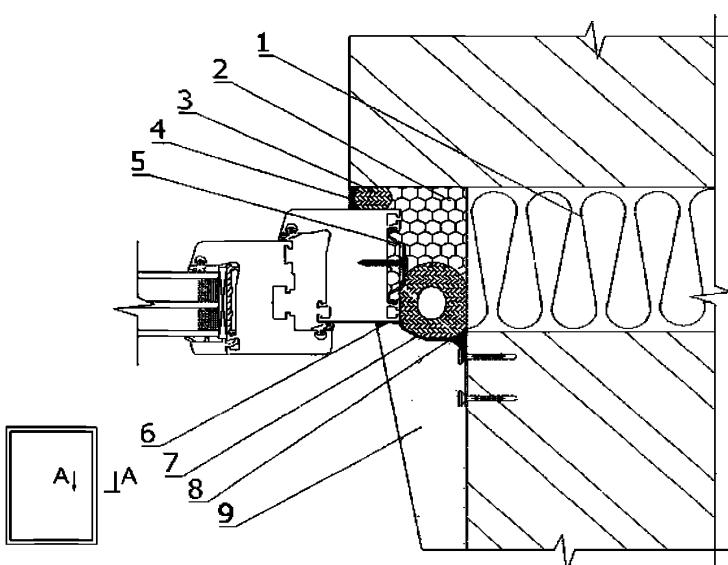
1 – утеплитель стены; 2 – пенный утеплитель; 3 – забутовочный шнур; 4 – атмосферостойкий паропроницаемый герметик; 5 – анкерная пластина; 6 – герметик; 7 – забутовочный шнур; 8 – пароизоляционный герметик; 9 – штукатурка
