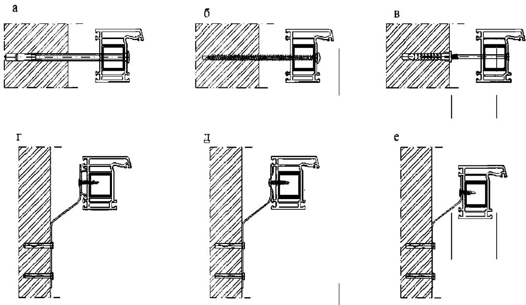
а – крепление распорным рамным дюбелем; б – крепление строительным шурупом;
