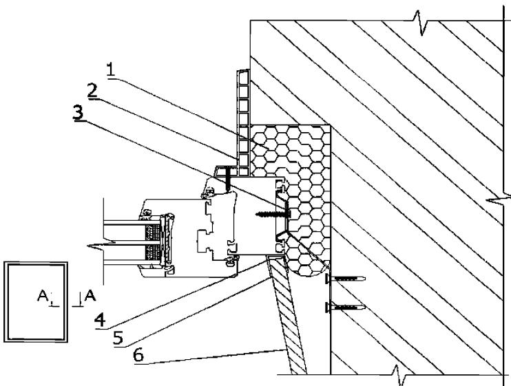
1 – пенный утеплитель; 2 – уголковый профиль из ПВХ; 3 – анкерная пластина; 4 – герметик;
