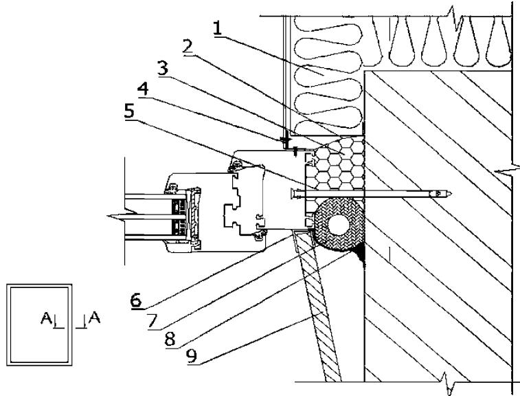
1 – фасадный утеплитель; 2 – гидроизоляционная диффузионная лента; 3 – пенный утеплитель;
