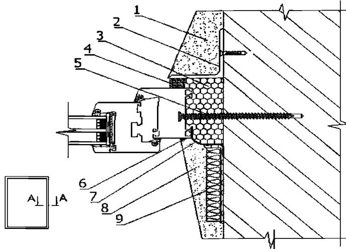
1 – штукатурка; 2 – уголковый профиль; 3 – пенный утеплитель; 4 – изоляционная саморасширяющаяся паропроницаемая лента; 5 – шуруп по бетону; 6 – герметик; 7 – пароизоляционная лента; 8 – штукатурка; 9 – теплоизоляционный вкладыш
