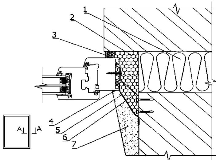
1 – утеплитель стены; 2 – пенный утеплитель; 3 – изоляционная саморасширяющаяся паропроницаемая лента; 4 – герметик; 5 – пароизоляционная лента; 6 – анкерная пластина; 7 – штукатурка
