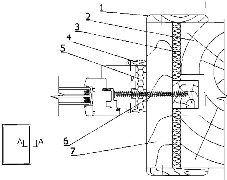
1 – нащельник; 2 – стена; 3 – пакля (лен); 4 – нащельник; 5 – пенный утеплитель;
