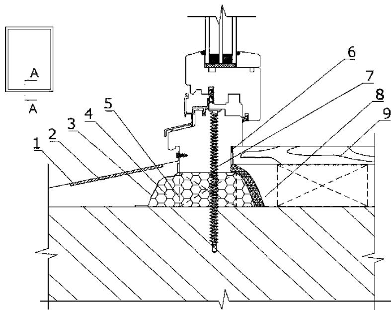
1 – слив; 2 – шумогасящая прокладка; 3 – гидроизоляционная диффузионная лента;
