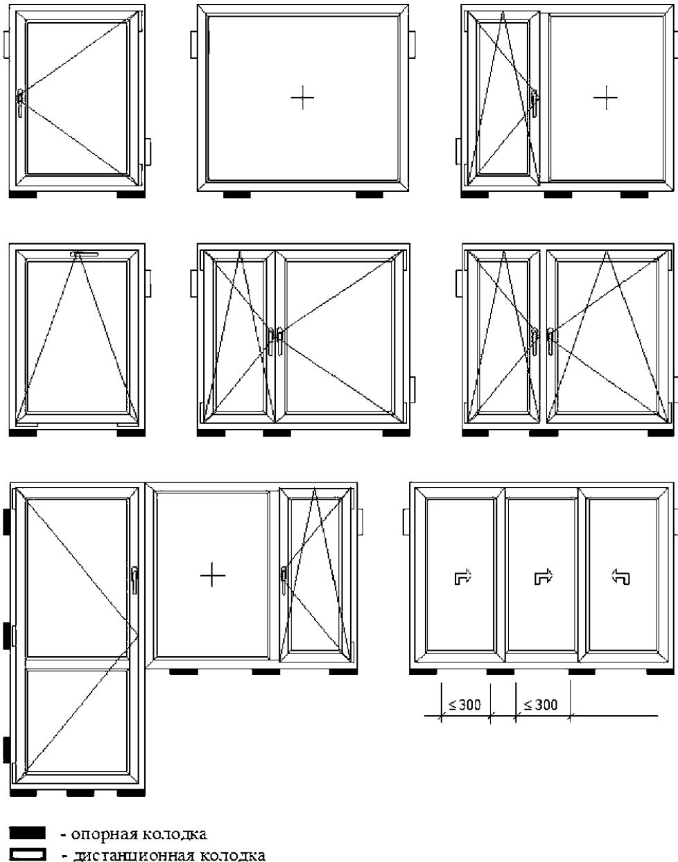
Рисунок Е.1 – Схемы расположения опорных и дистанционных колодок оконных блоков
