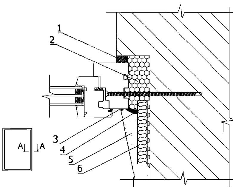
1 – изоляционная саморасширяющаяся паропроницаемая лента; 2 – пенный утеплитель; 3 – герметик;
