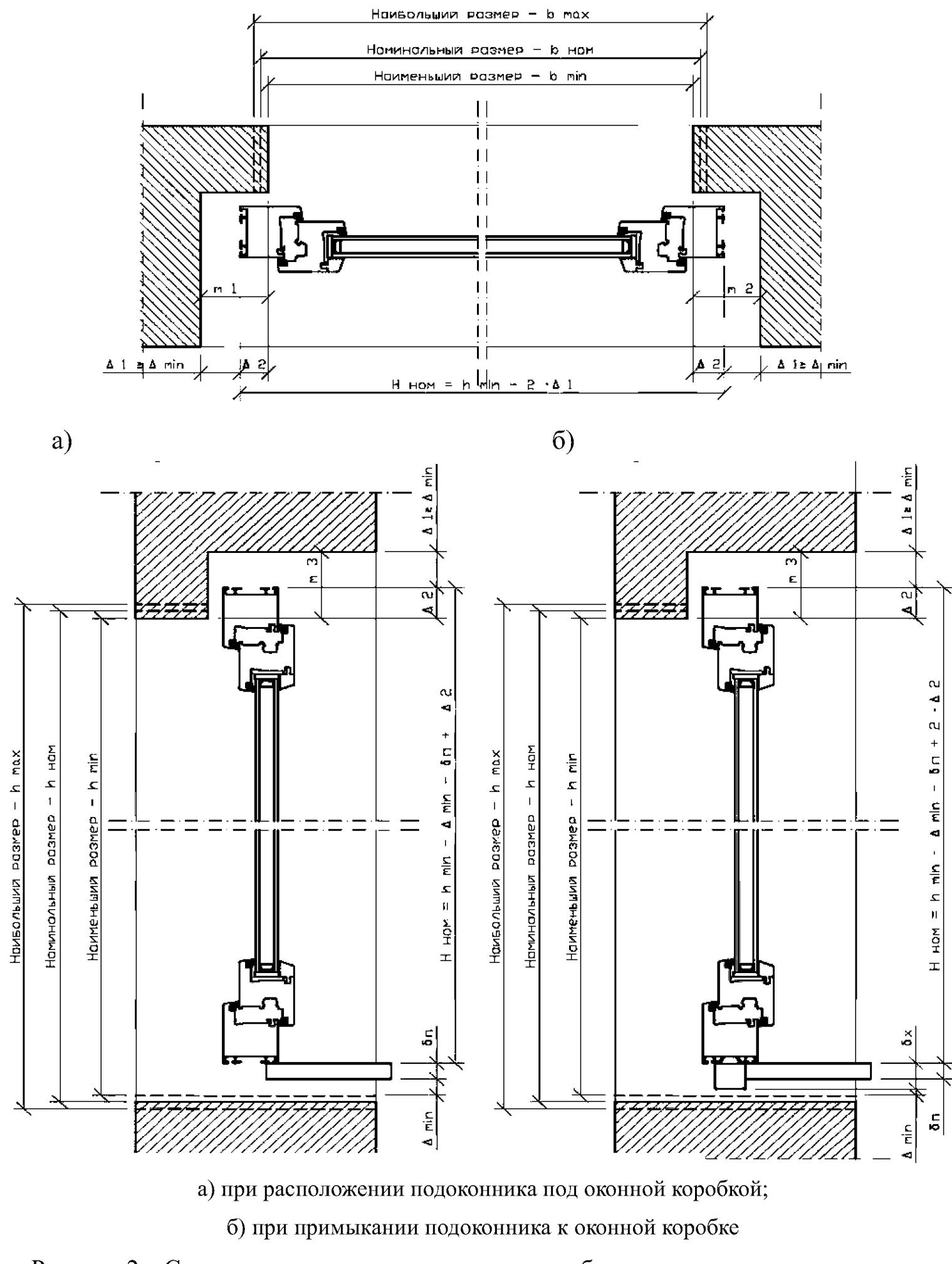
Рисунок 2 – Схема определения размеров оконных блоков в проемах наружных стен с четвертями
