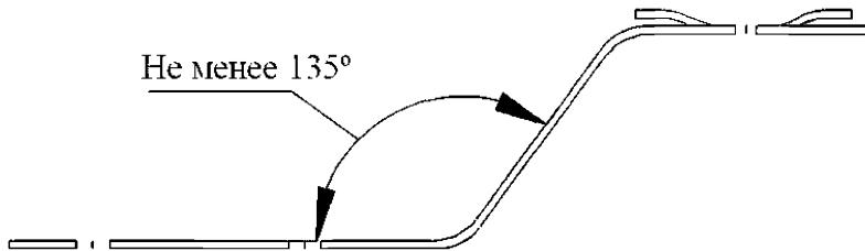
Рисунок Ж.2 – Рекомендуемый угол изгиба анкерной пластины
