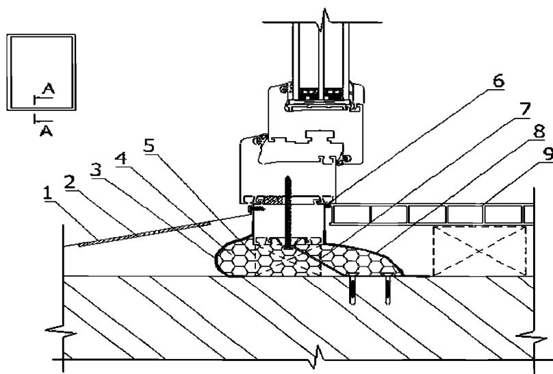
1 – слив; 2 – шумогасящая прокладка; 3 – гидроизоляционная диффузионная лента;
