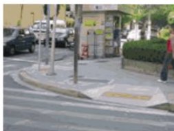
Рисунок 20 – Пример пандуса со скошенными боковыми гранями
