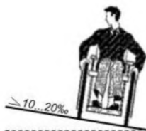
Рисунок 5 – Максимально допустимые значения поперечного уклона
