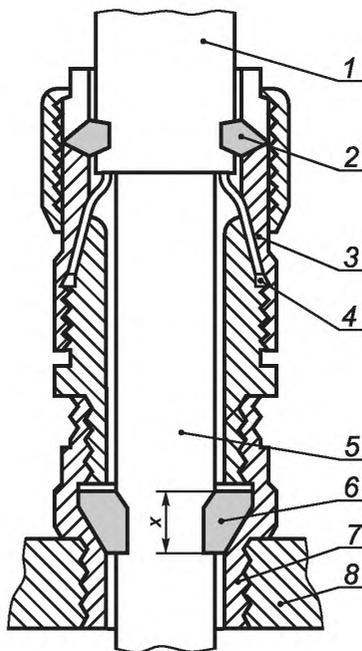
1 — внешняя оболочка кабеля; 2 — внешнее уплотнительное кольцо; 3 — крепящий зажим для брони; 4 — броня; 5 — оболочка внутренняя; 6 — уплотнительное кольцо; 7 — резьбовой ввод; 8 — стенка оболочки;  $x$  — осевая высота уплотнительного кольца.
