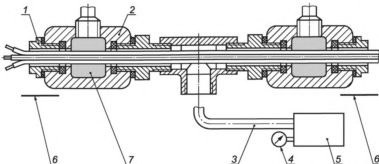
1 — уплотнения (удаляемые во время испытаний); 2 — узел герметичного вводного устройства; 3 — гибкий шланг;
