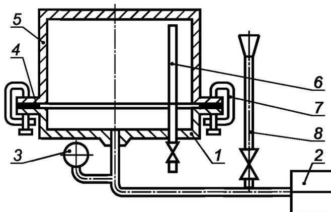
*1 — стенд для гидравлических испытаний; 2 — устройство для создания давления воды (насос); 3 — прибор для измерения давления; 4 — резиновая прокладка; 5 — испытываемая деталь; 6 — трубка для выхода воздуха при заполнении водой; 7 — трубочина для крепления испытываемой детали к стенду; 8 — трубка для предварительного заполнения оболочки водой.*
