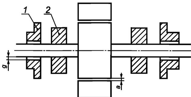
$a$  — радиальный зазор между статором и ротором;  $g$  — допустимое изменение радиального зазора в подшипниковом щите;
