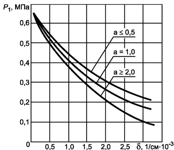
$A = V_2/V_1$  — кратность объемов отделения, в котором происходит разгрузка давления (объем  $V_2$ ) и смежного отделения (объем  $V_1$ ).
