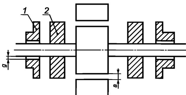
$a$  — радиальный зазор между ротором и статором;  $g$  — радиальное перемещение, допускаемое подшипниковым щитом;
