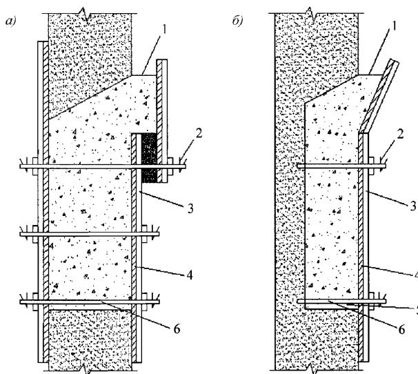
а) – двухсторонняя опалубка; б) – односторонняя опалубка
