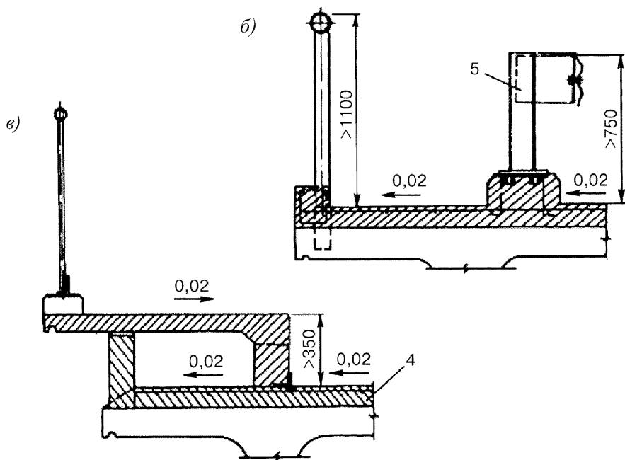
*a)* – тротуары; *б)* – тротуары непосредственно на пролетном строении; *в)* – тротуары повышенного типа;
