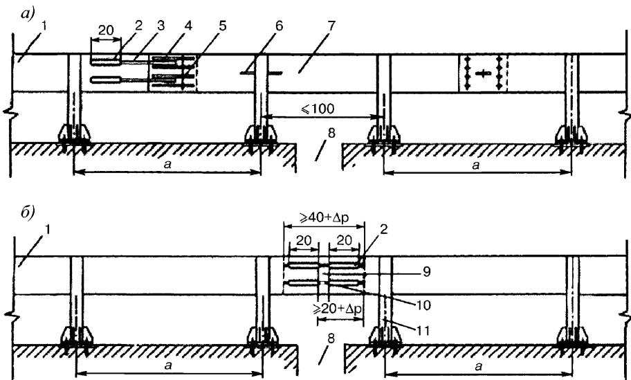
*a)* – при расчетном перемещении в швах пролетных строений менее 500 мм; *б)* – при расчетном перемещении в швах пролетных строений более 500 мм;
