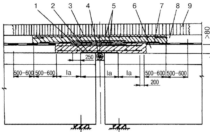
1 – упругая прокладка; 2 – арматура соединительной плиты; 3 – арматура защитного слоя;
