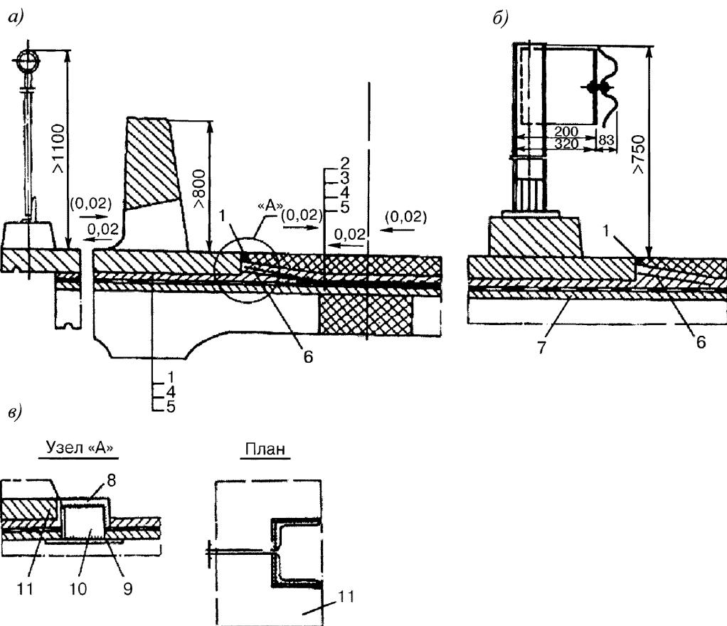
а) – с парапетным ограждением; б) – с металлическим барьерным ограждением; в) – крепление тротуарного блока (в скобках приведены значения при водоотводе через трубы);
