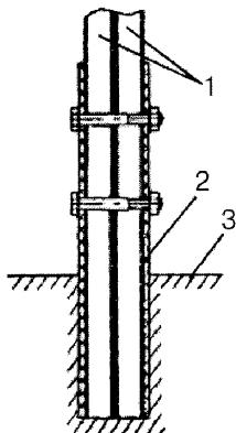
1 – стойки секций; 2 – закладной элемент из композиционных материалов; 3 – дорожное полотно
