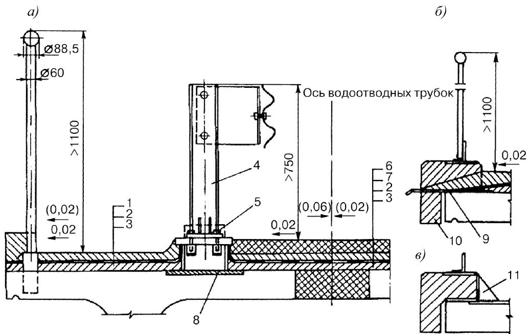
*a)* – без карнизного блока; *б)* – с карнизовым блоком; *в)* – крепление карнизного блока (в скобках приведены значения при водоотводе через трубки);
