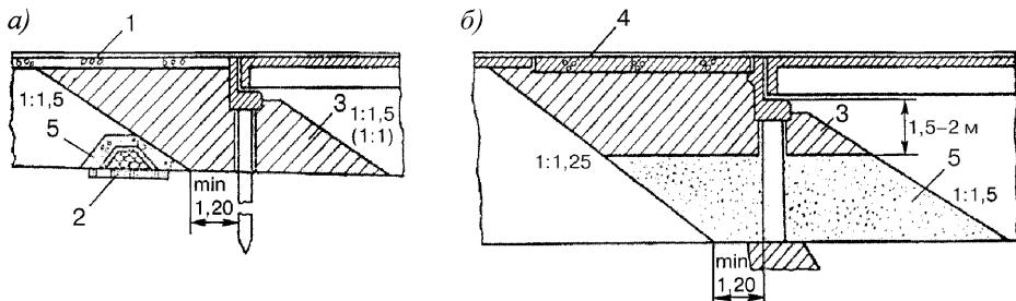
*a)* – при высоте насыпи до 3 м; *б)* – при высоте насыпи более 3 м;
