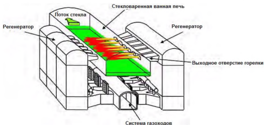
Рисунок 2.1.1 — Регенеративная стекловаренная печь с поперечным направлением пламени [11]
