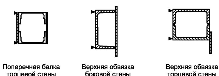
Рисунок К.1 — Схема установки тензорезисторов на раме полурамы
