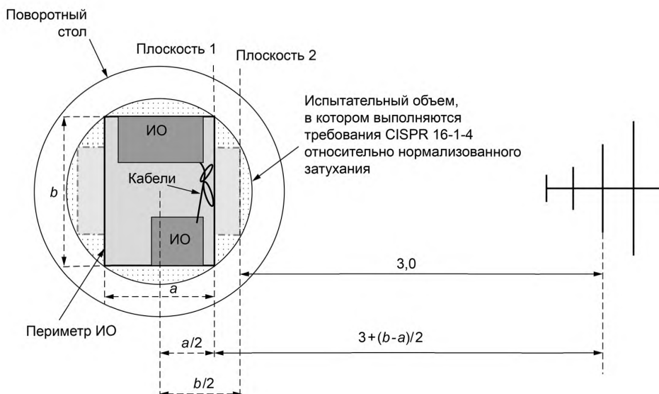
Рисунок 10 — Положение опорных плоскостей при калибровке однородного поля (вид сверху)
