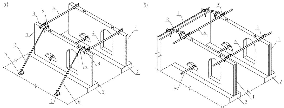
1 – стеновая панель; 2 – фундамент; 3 – осевой зажим; 4 – распорка;
