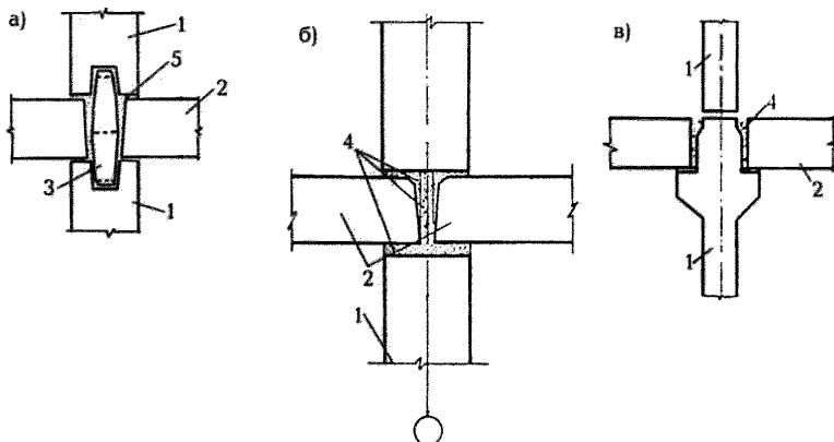
1 – стеновая панель; 2 – плиты перекрытия; 3 – фиксатор; 4 – цементно-песчаный раствор
