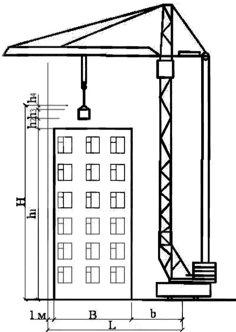
Н – высота подъема крюка;  $h_1$  – высота последнего монтажного горизонта от уровня стоянки крана;  $h_2$  – высота подъема сборной конструкции над опорой ( $h_2 = 1$  м);
