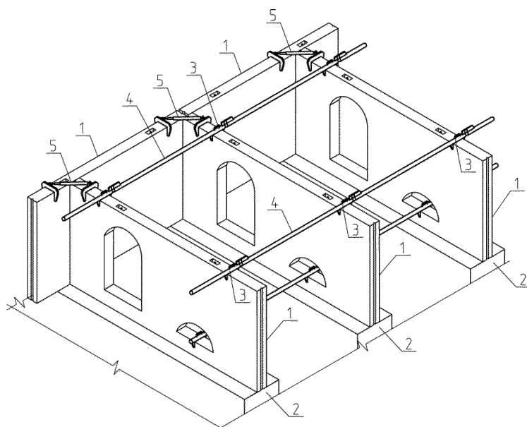
1 – стеновая панель; 2 – фундамент; 3 – осевой зажим; 4 – распорка; 5 – угловая связь
