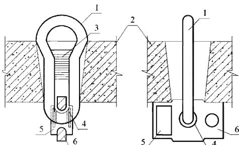
1 – петля; 2 – плита перекрытия; 3 – ребро жесткости;
