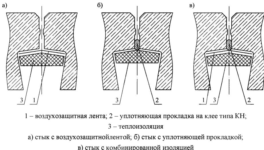
Рисунок8.7 – Варианты устройства воздухозащитной изоляции
