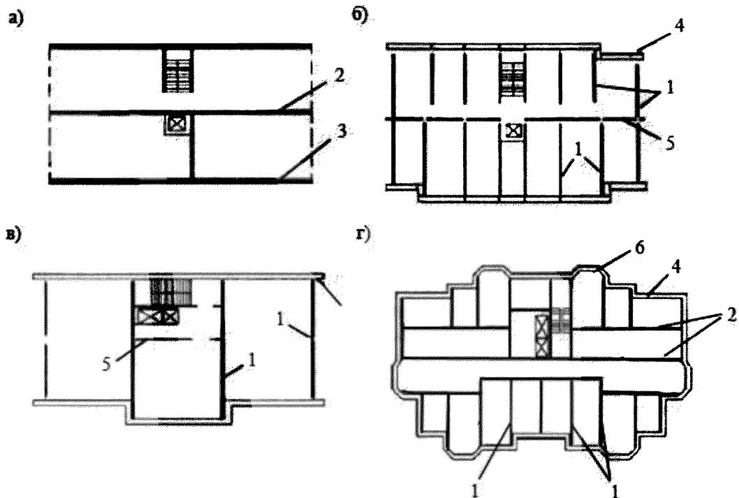
1 – несущие поперечные стены; 2 – несущие продольные стены;
