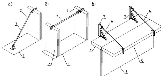
1 – плита перекрытия; 2 – панель стеновая; 3 – подкос; 4 – распорка;
