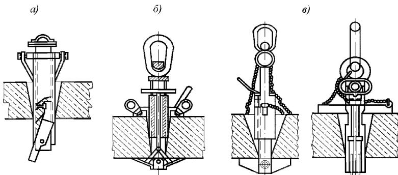
а) захват коромыслового типа; б) стержневой захват (резьбовой вариант);
