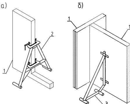
1 – стеновая панель; 2 – фиксатор; 3 – упор
