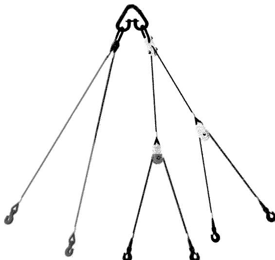
Рисунок 6.2 – Балансирный шестиветвевой строп с роликами
