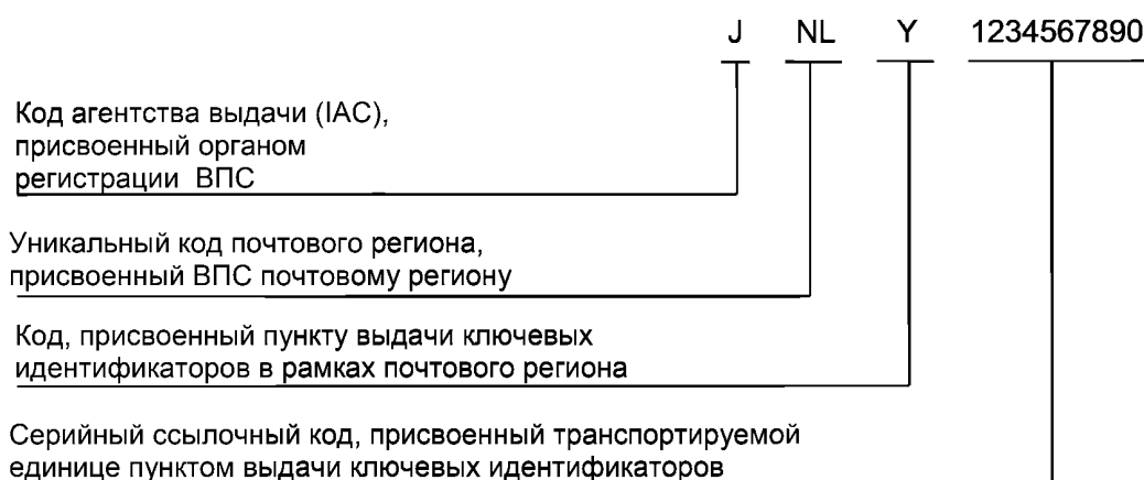
Рисунок А.2 — Строка ASC MH10, используемая ВПС, выступающим в качестве агентства выдачи
