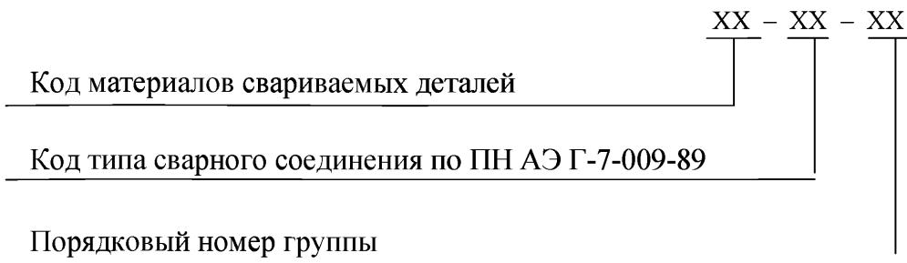
Рисунок 4.1 – Структура обозначения группы однотипных сварных соединений
