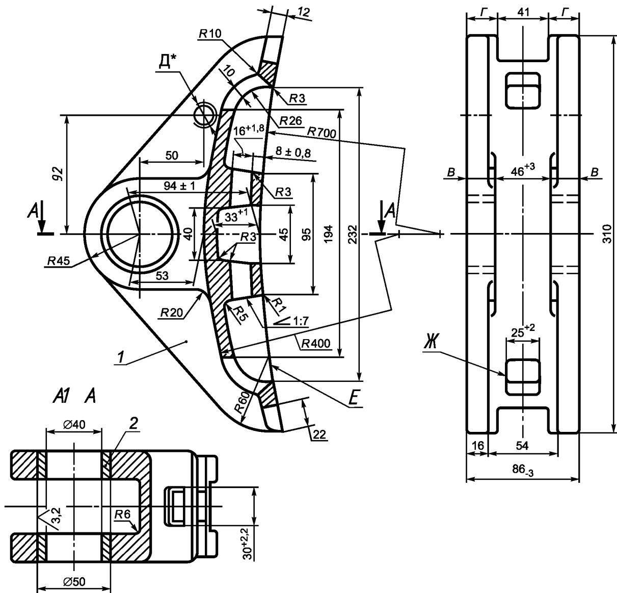
\* Необходимость и размеры отверстия Д определяются конструкцией подвески башмака.
