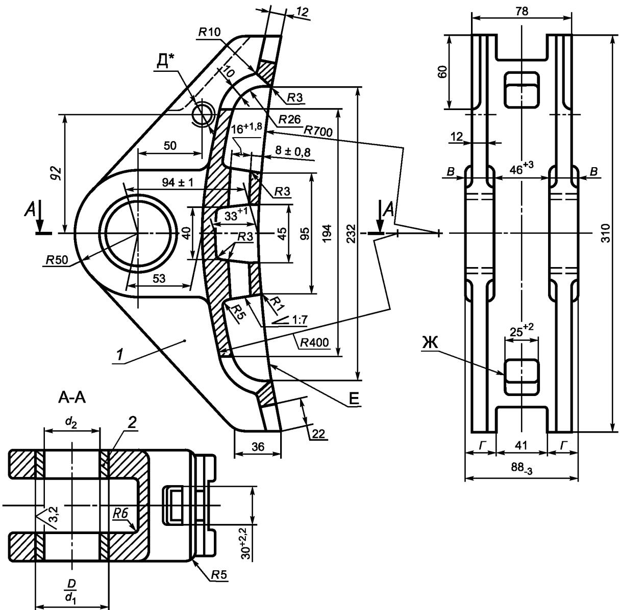
\* Необходимость и размеры отверстия Д определяются конструкцией подвески башмака.
