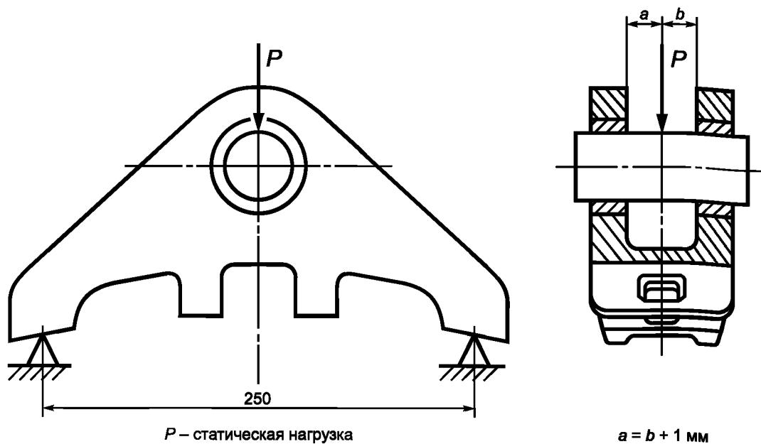
Рисунок Б.1 — Схема испытания башмака статической нагрузкой
