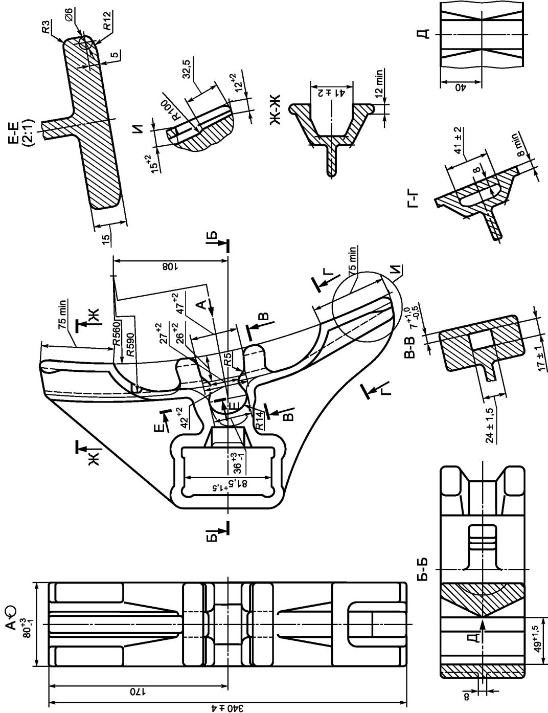
Рисунок 4 — Башмак — тип 1 (Исполнение 3)
