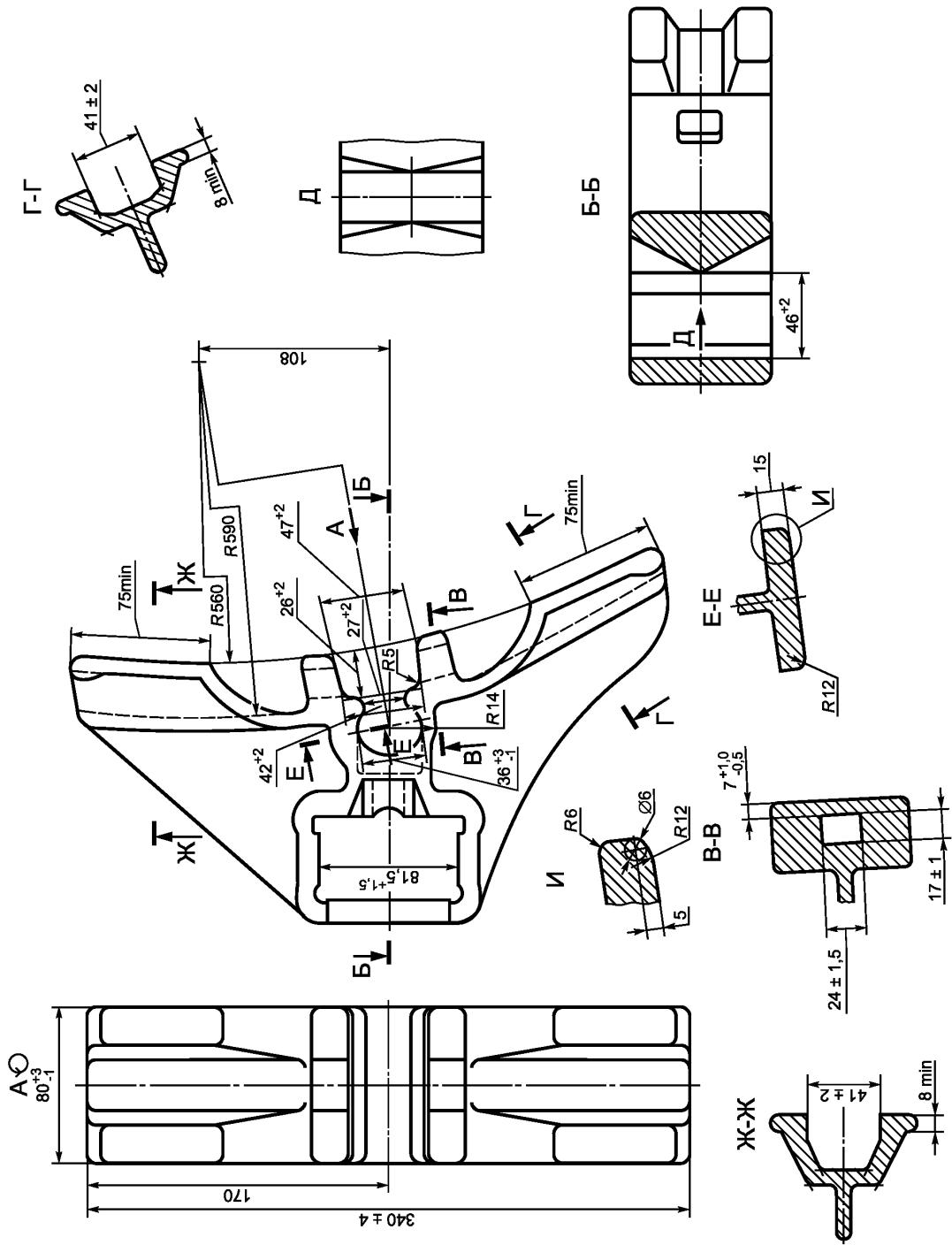
Рисунок 3 — Башмак — тип 1 (Исполнение 2)
