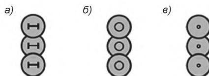
а) — дутавром; б) — трубой; в) — теряемыми буровыми штангами с накатанной винтовой поверхностью
