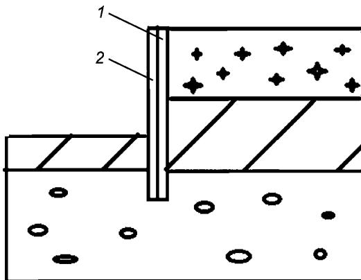
1 — грунтоцементный элемент; 2 — армирующий элемент
