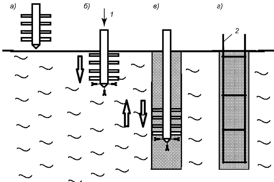
а) — установка бурового оборудования в рабочее положение; б) — погружение в грунт смесителя до проектной отметки вращательным бурением и нагнетание цементного раствора через смеситель для смешения с грунтом;
