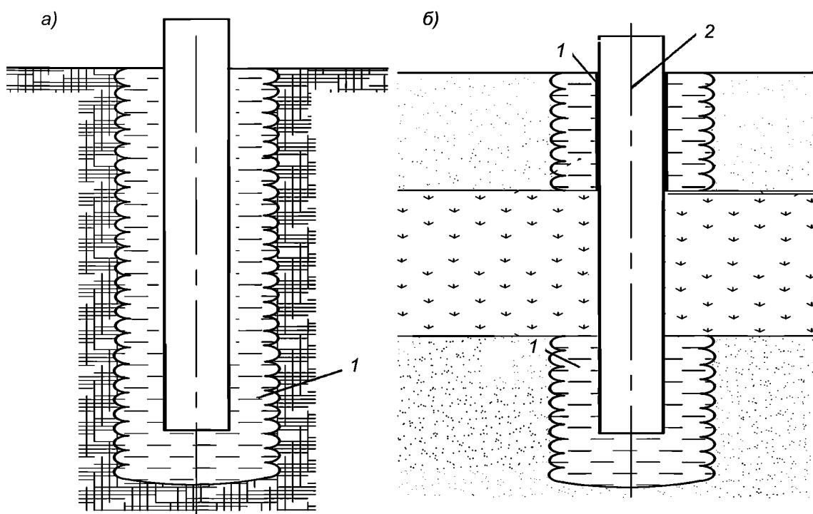
а) — схема комбинированной сваи с сердечником; б) — схема комбинированной сваи в намывных и просадочных грунтах;
