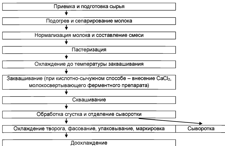
Рисунок 2.9 – Технологическая схема производства творога
