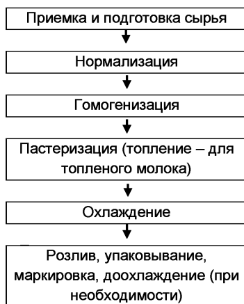
Рисунок 2.1 – Технологическая схема производства пастеризованного и топленого молока (пастеризованных сливок)
