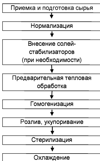
Рисунок 2.2 – Технологическая схема производства стерилизованного молока (сливок)
