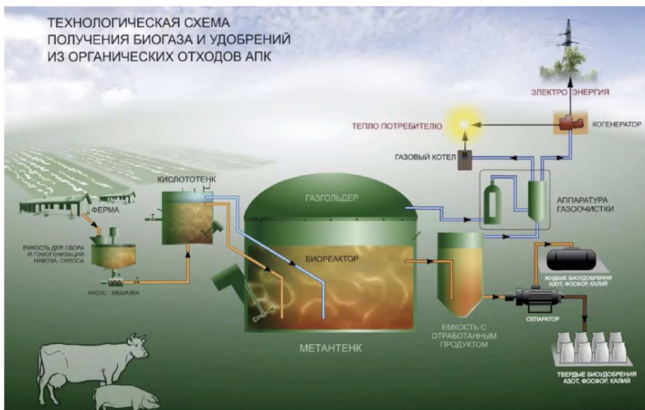
Рисунок 7.12 – Технологическая схема получения биогаза и удобрений из органических отходов АПК
