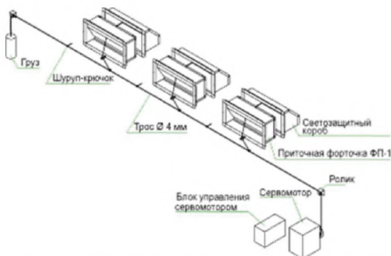
Рисунок 2.30 — Устройства для механического открытия приточных клапанов
