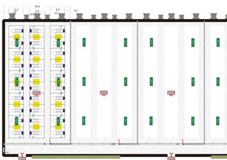
Рисунок 2.41 — Типовая схема установки газовых теплогенераторов в зданиях подсосных свиноматок и поросят на дорастивании
