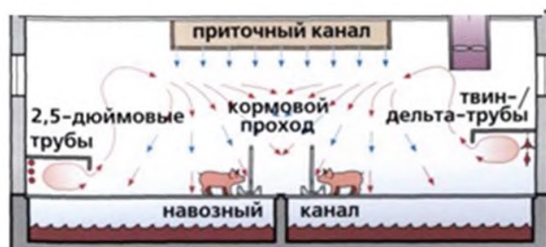
Рисунок 2.45 Если над дельта или твин-трубами устанавливаются навесы, то в логове поросенка удается создать комфортный микроклимат.
