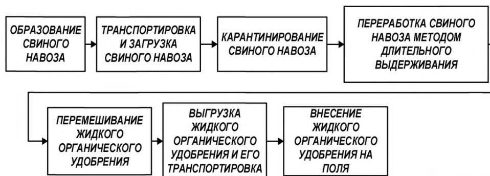
Рисунок 2.61 — Блок-схема технологии переработки свиного навоза в органическое удобрение методом длительного выдерживания
