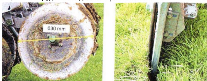
Рисунок 2.74 — Внутрипочвенное внесение под давлением жидкого органического удобрения в открытые бороздки
