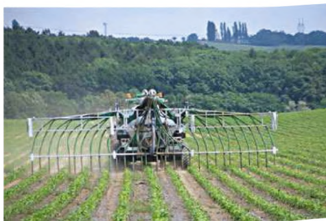
Рисунок 2.72 — Поверхностное внесение жидкого органического удобрения через распределитель с системой навесных шлангов
