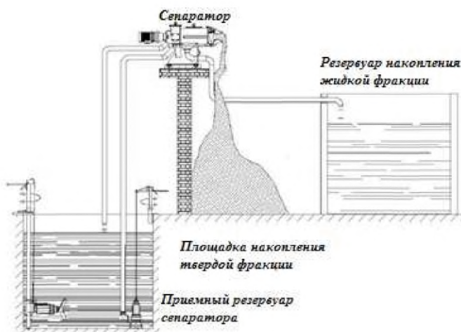
Рисунок 2.65 — Схема разделения свиного навоза на фракции
