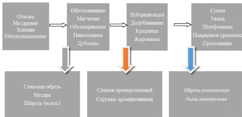
Рисунок 2.4 — Схема образования побочных продуктов в технологическом процессе
