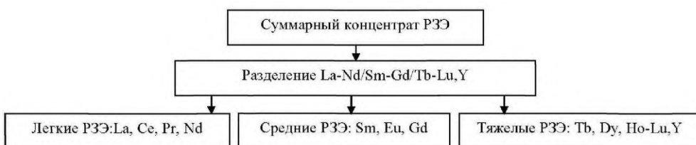
Рисунок 2.16 – Схема 2 разделения группового бастинезитового концентрата РЗЭ, реализованная на предприятиях в Китае
