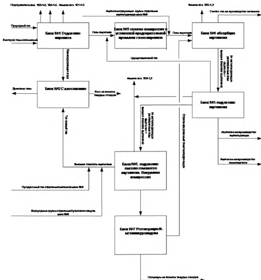
Рисунок 2.16 — Принципиальная технологическая схема производства ацетилена
