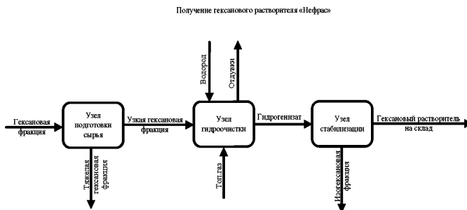
Рисунок 2.6 — Принципиальная технологическая схема получения гексанового растворителя «Нефрас»
