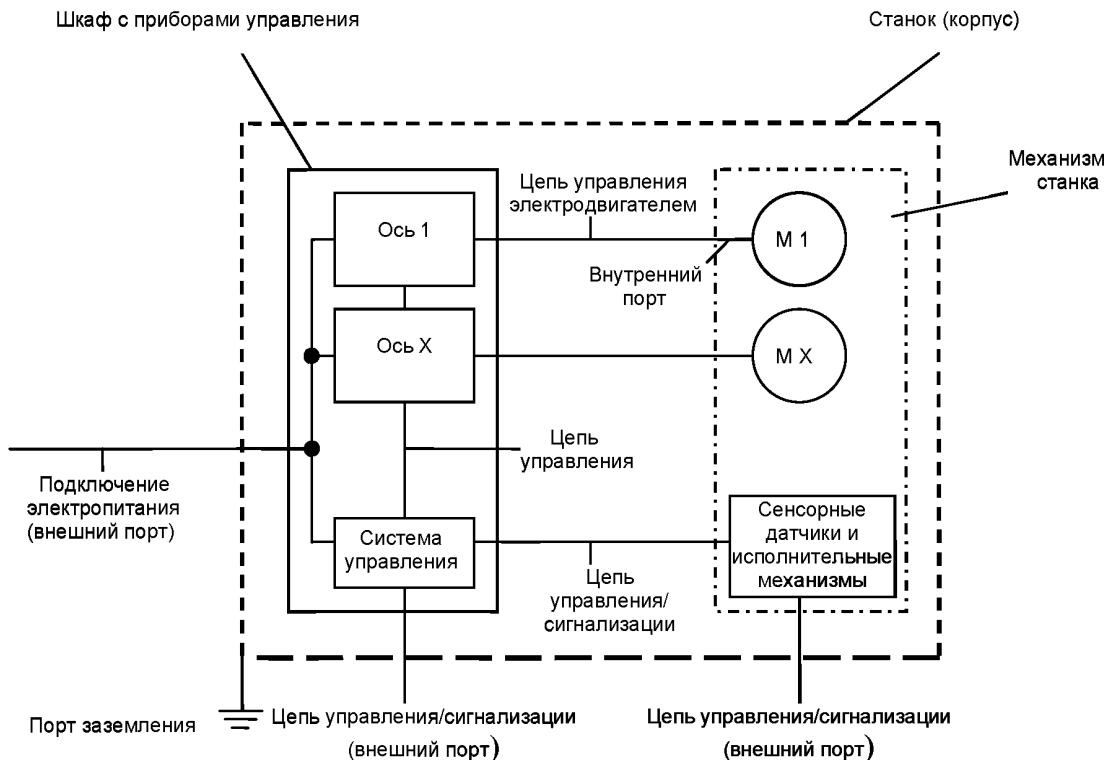
Рисунок 1 – Конфигурация системы и примеры соединений
