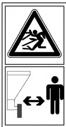
Рисунок В.2 – Опасности, связанные с выбросом материалов
