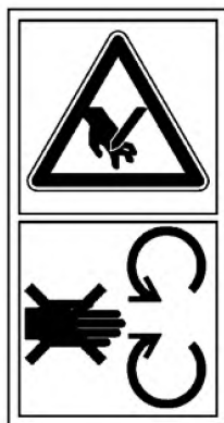
Рисунок В.1 – Опасности, связанные с движущимися частями
