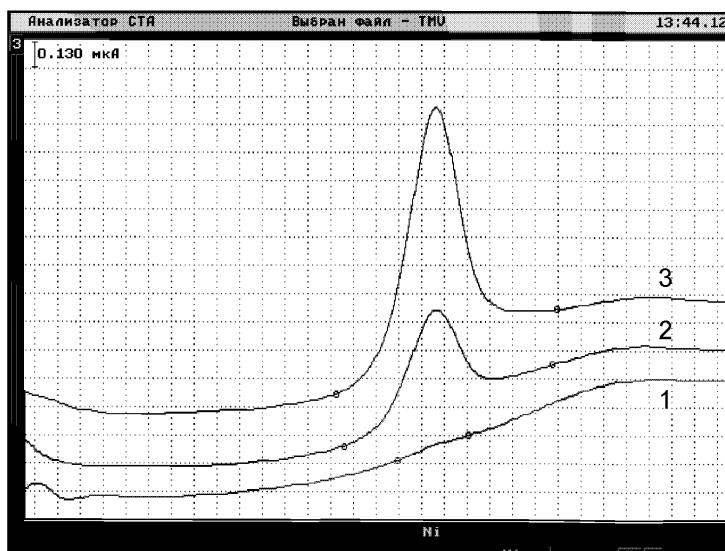
Рисунок 9 - Вольтамперограммы при регистрации аналитических сигналов никеля в фоновом электролите (1), в пробе (2) и в пробе с добавкой (3) АС никеля
