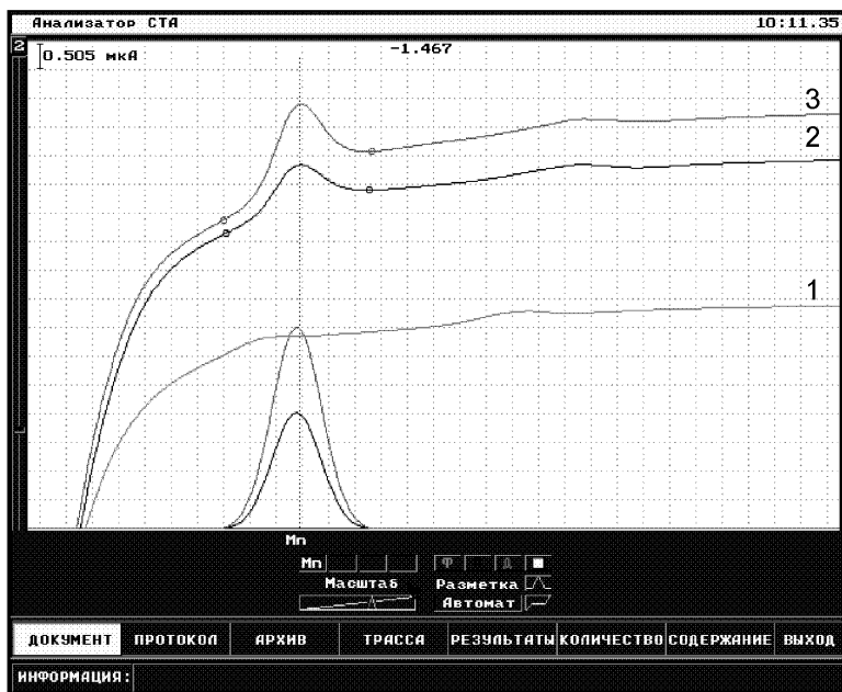
Рисунок 5 Вольтамперограммы при регистрации аналитических сигналов определения марганца в фоновом электролите (1), в пробе (2) и в пробе с добавкой АС марганца (3)
