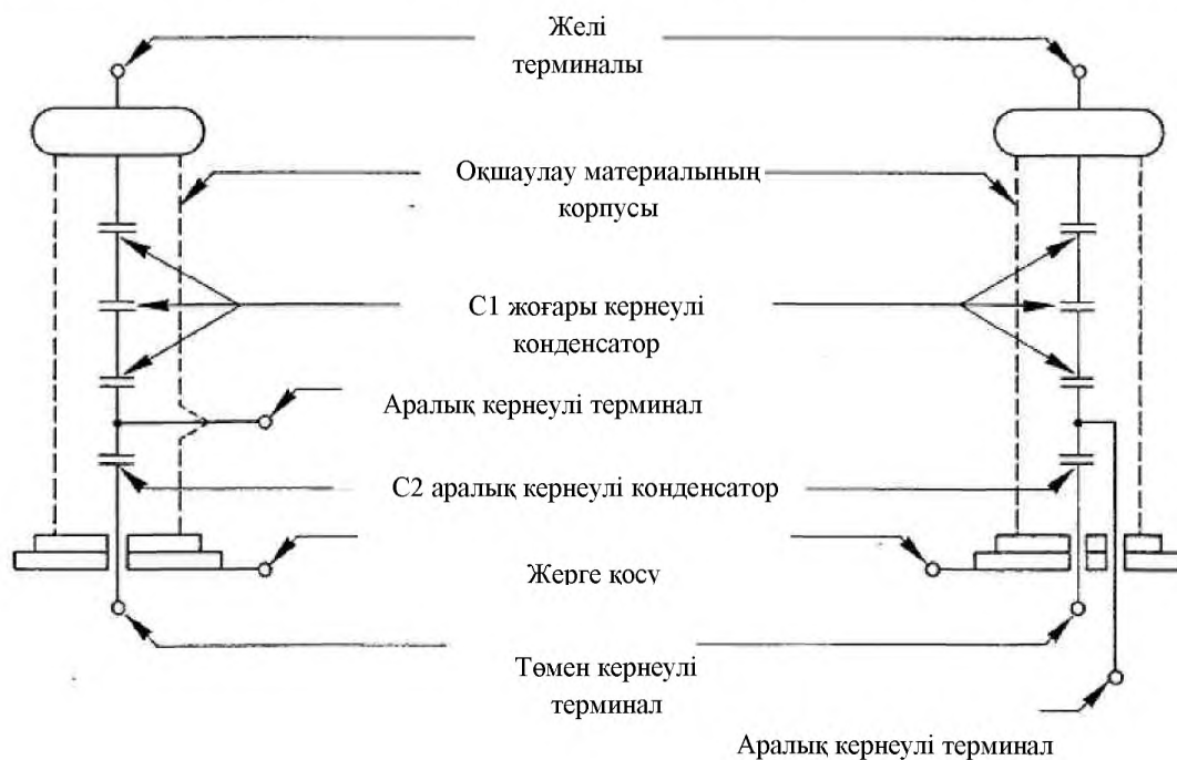
А3 суреті – Конденсаторлық бөлгіш (жоғары жиілікті электр беру желісіне арналған байланыс үшін пайдаланылмайтын конденсаторлық трансформатордың бөлігі)
