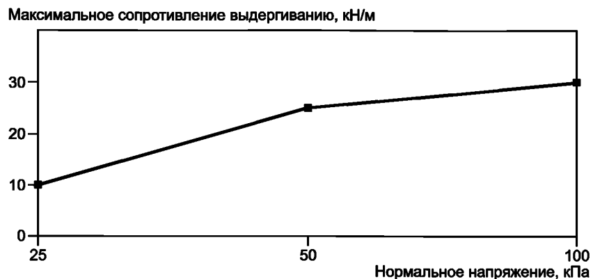
Рисунок А.4 — Пример графика зависимости максимального сопротивления выдергиванию от нормального напряжения
