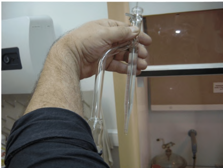
Рисунок Б-17 – Определение количества выделенной воды по рискам после охлаждения ловушки
