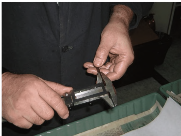
Рисунок Б-9 – Измерение толщины образцов изоляции
