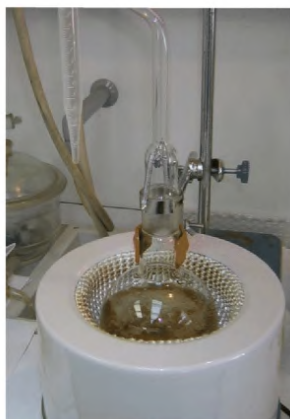
Рисунок Б-14 – Колба с образцами в колбонагревателе после удаления стеклоткани
