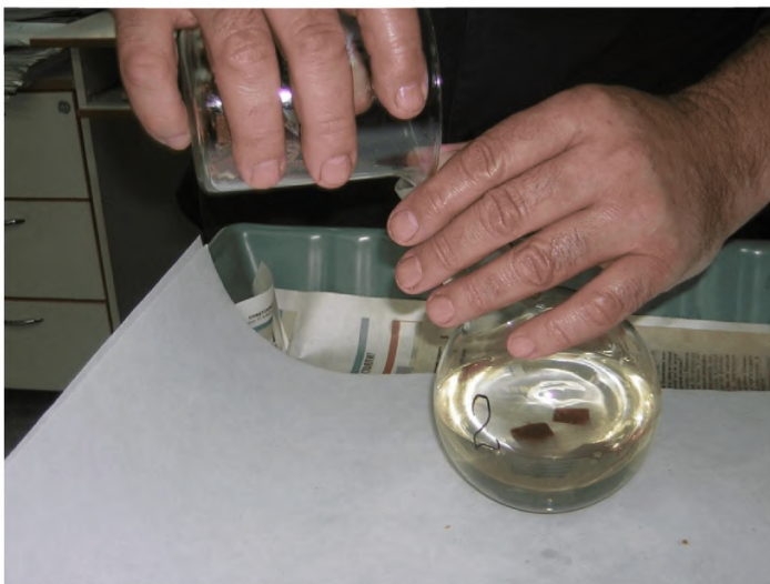
Рисунок Б-12 – Перемещение разрезанного образца изоляции из стакана в колбу с просушенным уайт-спиритом
