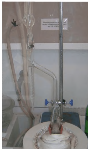
Рисунок Б-2 – Аппарат АКОВ-10 в вытяжном шкафу в процессе кипячения уайт-спирита (верхняя часть колбы закрыта стеклотканью)
