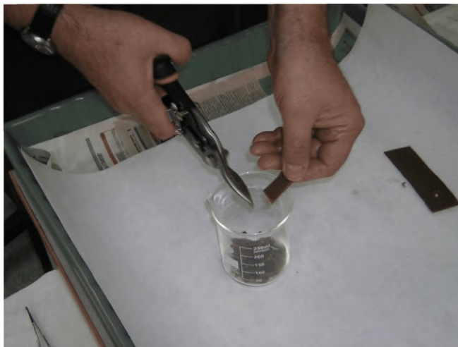
Рисунок Б-10 – Подготовка навески образца изоляции
