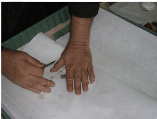
Рисунок Б-7 – Протирка образца фильтровальной бумагой
