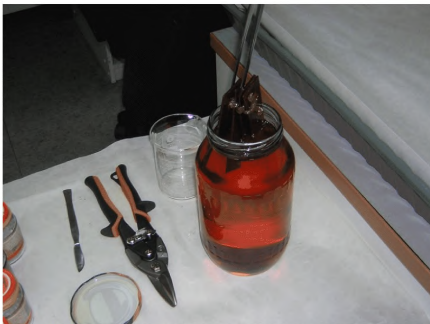
Рисунок Б-5 – Извлечение образца целлюлозной изоляции из сосуда
