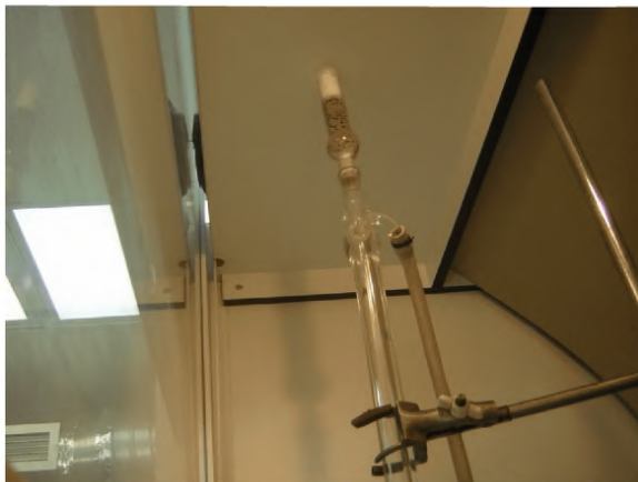
Рисунок Б-13 – Патрон с осушителем, установленным на холодильнике аппарата АКОВ-10
