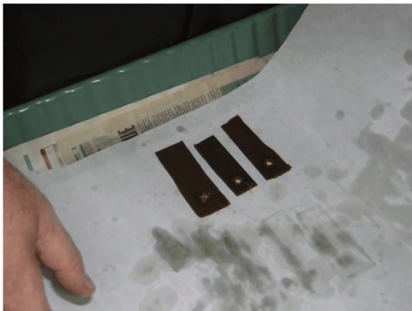
Рисунок Б-8 – Протирка изоляции фильтровальной бумагой
