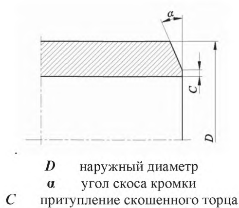
Рисунок 1 — Скос торца трубы
