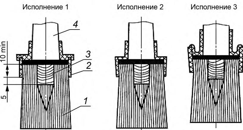
Рисунок А.1 — Исполнения кистей-ручников типов КР, КРО. Исполнения 1—3
