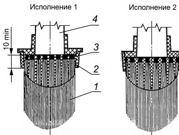
Рисунок А.2 — Исполнения кистей-ручников типа КРС. Исполнения 1, 2
