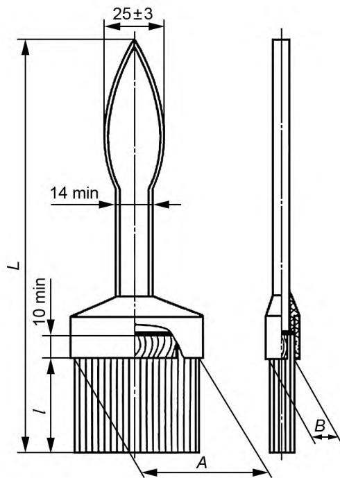
Рисунок 9 — Кисть флейцевая типа КФ. Исполнение 2
