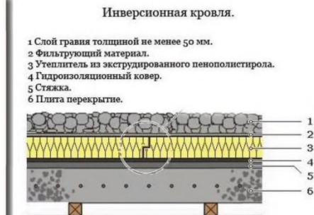
Рисунок 6.1.13 – Пример обычной и инверсионной кровли
