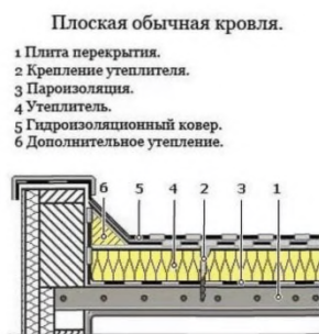
Рисунок 6.1.13 – Пример обычной и инверсионной кровли
