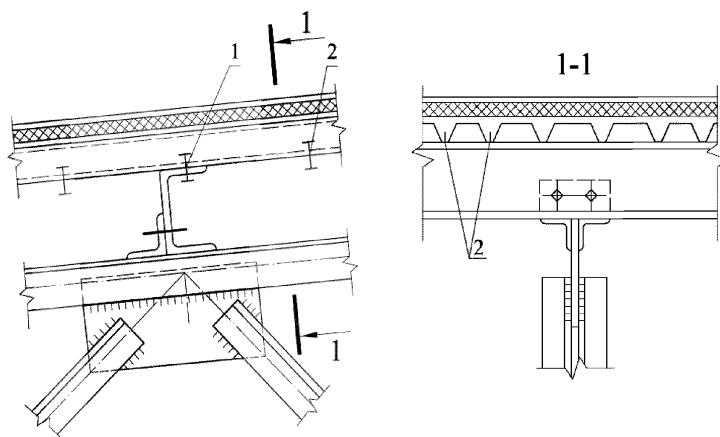
Рисунок 36 – Узел крепления прогонов
