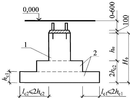
Рисунок 14 – Столбчатый фундамент при соединении со стальной колонной
