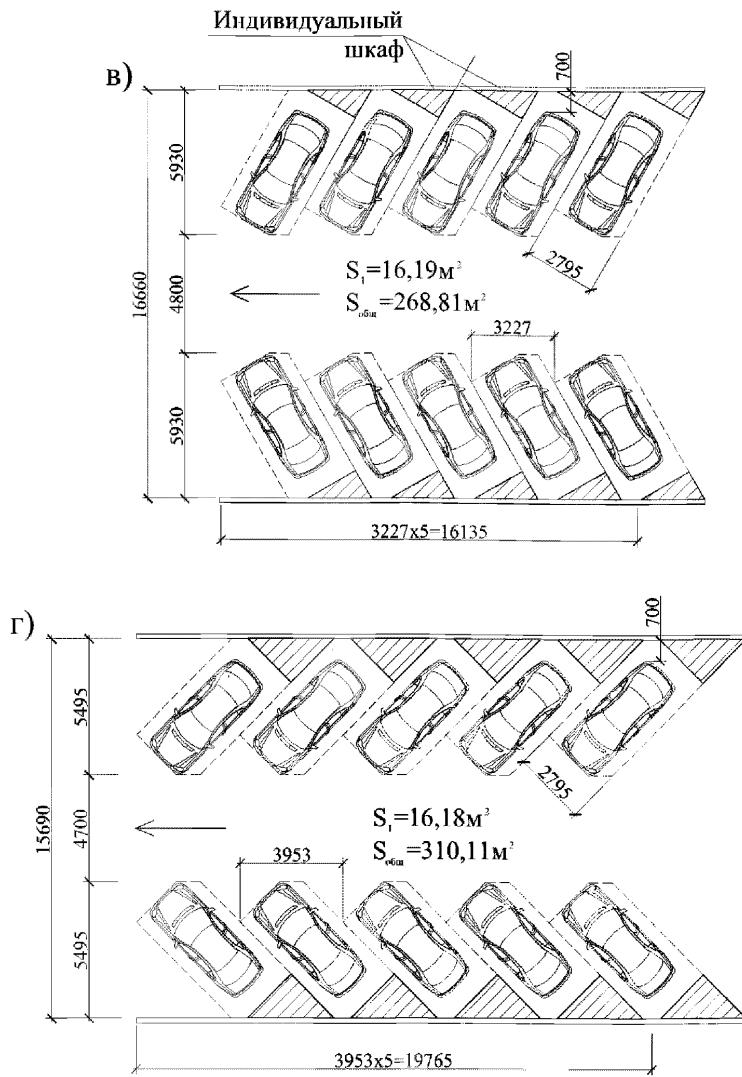
Рисунок 6.2 - Фрагменты планов расстановки автомобилей большого класса:
