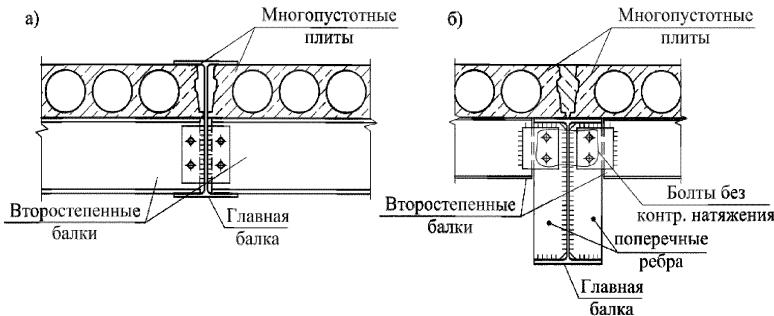
Рисунок 30 –Опирание железобетонных плит на второстепенные балки
