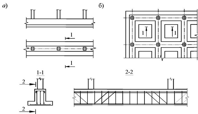
Рисунок 15 – Ленточные монолитные фундаменты под колонны
