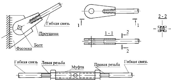
Рисунок 39 – Конструкция гибкой связи из круглой стали
