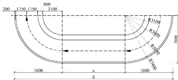
Рисунок 12 - Минимальная горизонтальная проекция однопутной прямолинейной одномаршевой рампы
