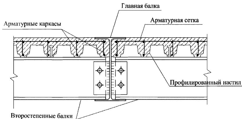
Рисунок 28 –Конструкция монолитного железобетонного перекрытия с второстепенными балками
