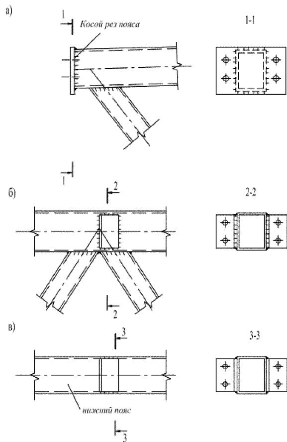
Рисунок 34 – Узлы ферм из гнутосварных профилей
