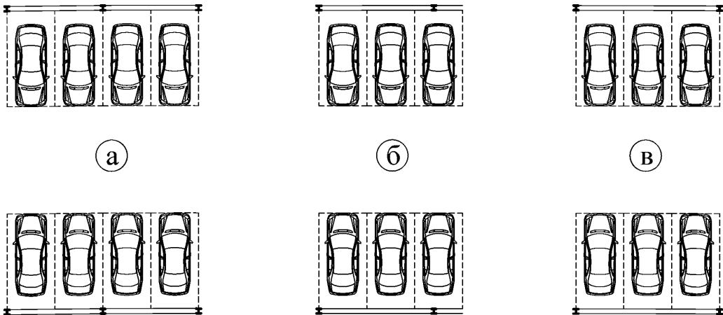
Рисунок 18. Фрагменты планов с манежной расстановкой автомобилей среднего класса под углом 90°
