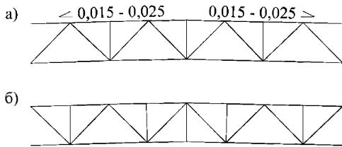
Рисунок 31 – Геометрические схемы ферм с параллельными поясами
