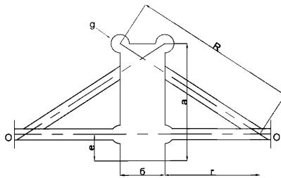
Рисунок 5 - Шаблон для определения ширины проезда
