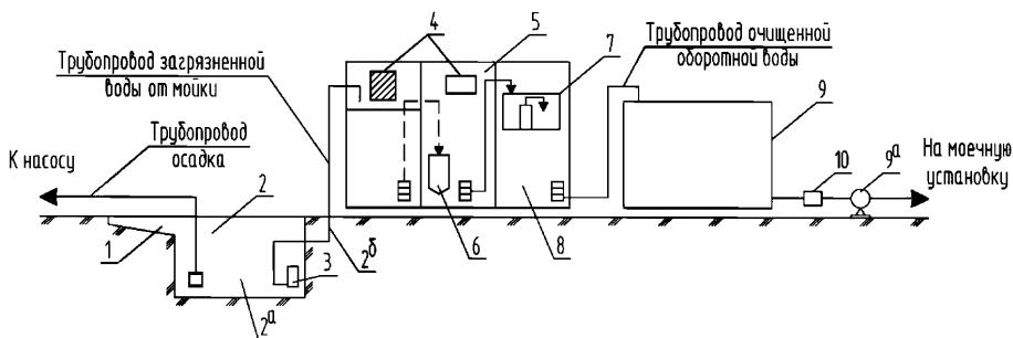
Рисунок 13 - Схема очистных сооружений оборотного водоснабжения ручной мойки.
