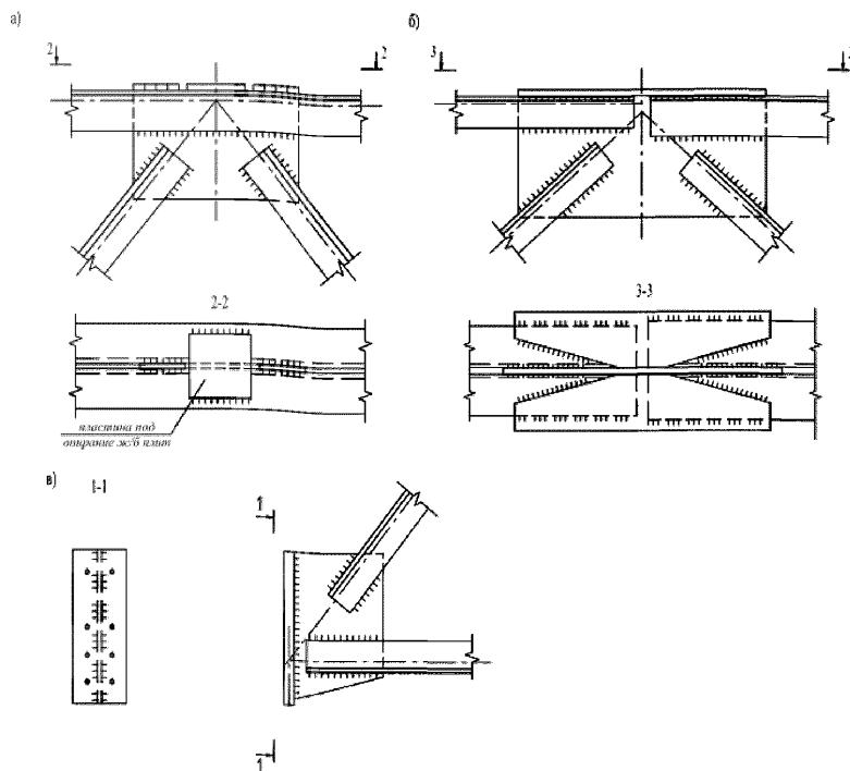
Рисунок 32 – Узлы ферм из парных горячекатанных уголков
