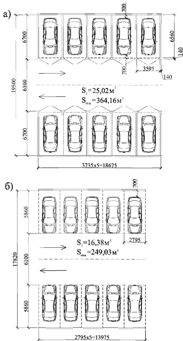
Рисунок 6.1 - Фрагменты планов расстановки автомобилей большого класса:
