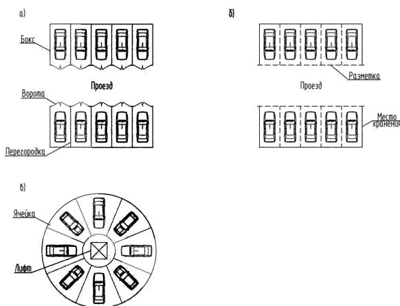
Рисунок 1 - Способы хранения автомобилей
