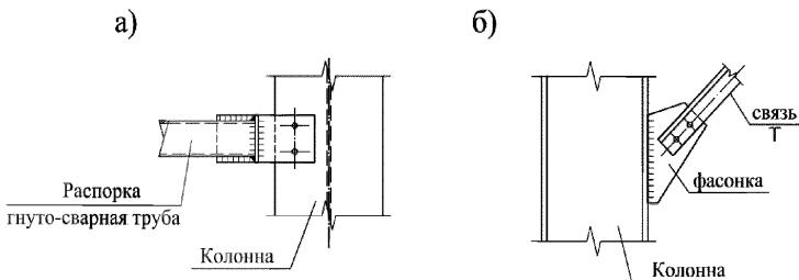
Рисунок 38 – Узел крепления связи к колонне
