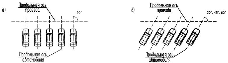
Рисунок 4 - Схемы расстановки автомобиля в зоне хранения
