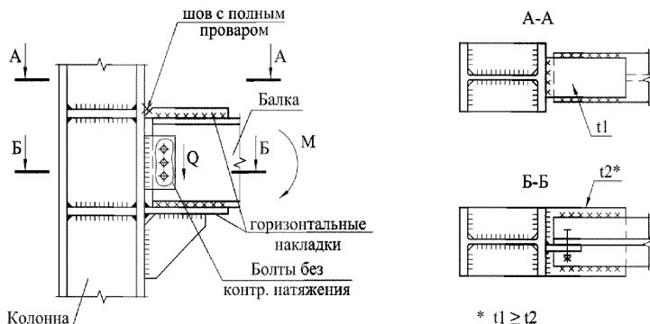
Рисунок 24 – Рамный узел крепления балки на сварке
