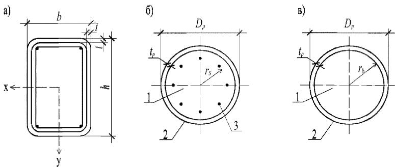
Рисунок 17 – Сечения трубобетонных колонн
