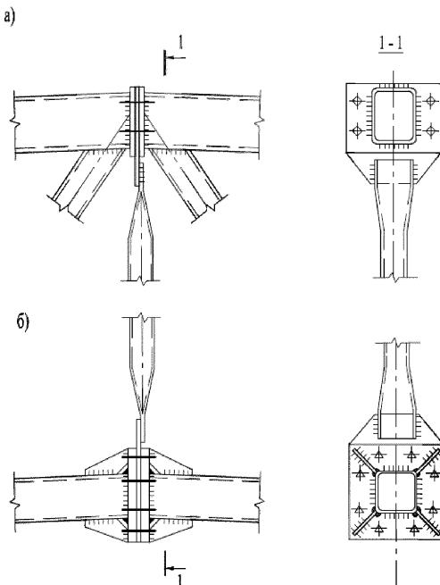
Рисунок 35 – Узлы ферм из гнутосварных профилей
