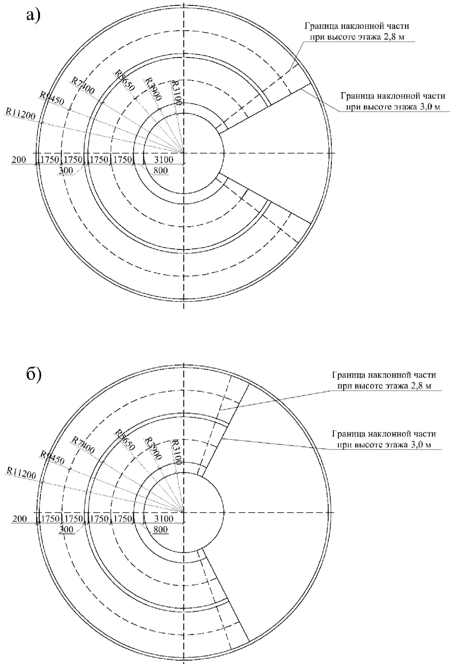
Рисунок 10 - Минимальная горизонтальная проекция двухпутной криволинейной рампы
