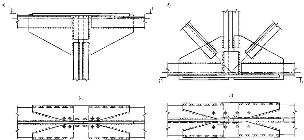
Рисунок 33 – Монтажныестыки ферм из парных горячекатанных уголков
