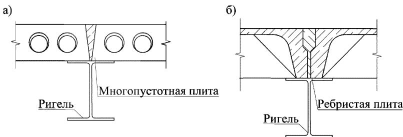
Рисунок 29 –Опирание железобетонных плит на ригели поверху
