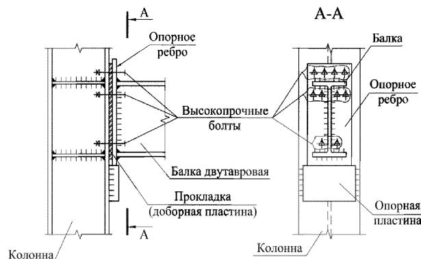
Рисунок 23 – Рамный узел крепления балки на фланцах
