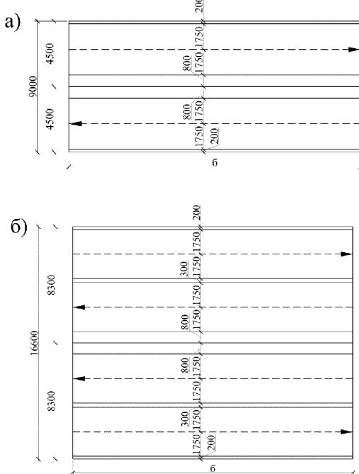
Рисунок 11 - Минимальная горизонтальная проекция прямолинейной полурампы (аппарели)
