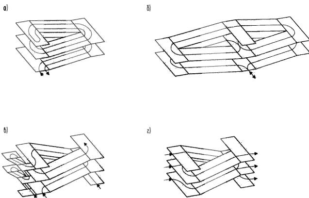
Рисунок 8 - Типы пространственной организации «скатных стоянок»:
