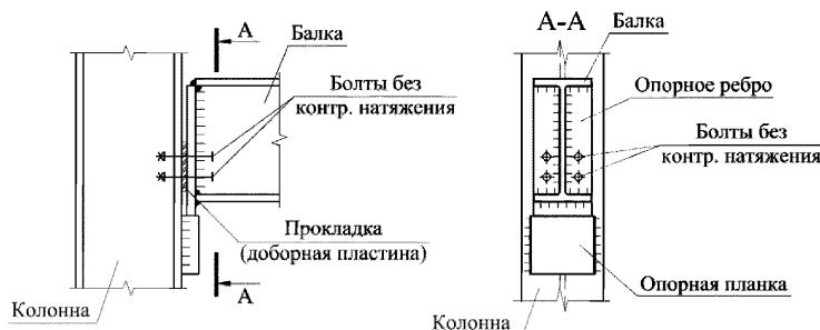
Рисунок 20 – Шарнирный узел опирания балки через опорную пластину
