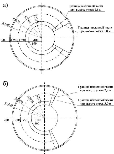
Рисунок 9 - Минимальная горизонтальная проекция однопутной криволинейной рампы
