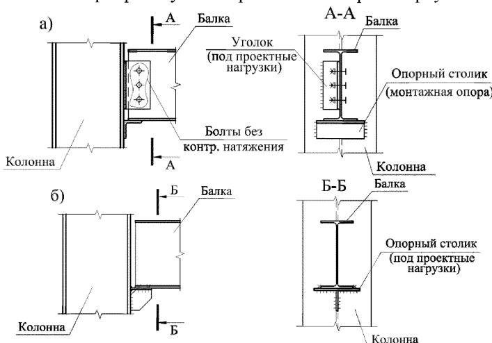
Рисунок 21 – Шарнирный узел опирания балки через опорный столик
