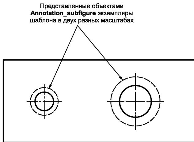
Рисунок 1 — Экземпляры шаблона, используемые для обозначения отверстия
