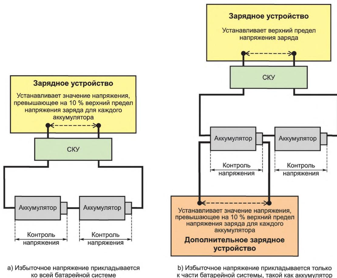
Рисунок 6 — Пример конфигурации схемы управления напряжением при перезаряде
