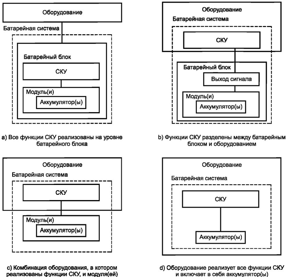
Рисунок 5 — Примеры расположения СКУ и конфигураций батарейной системы
